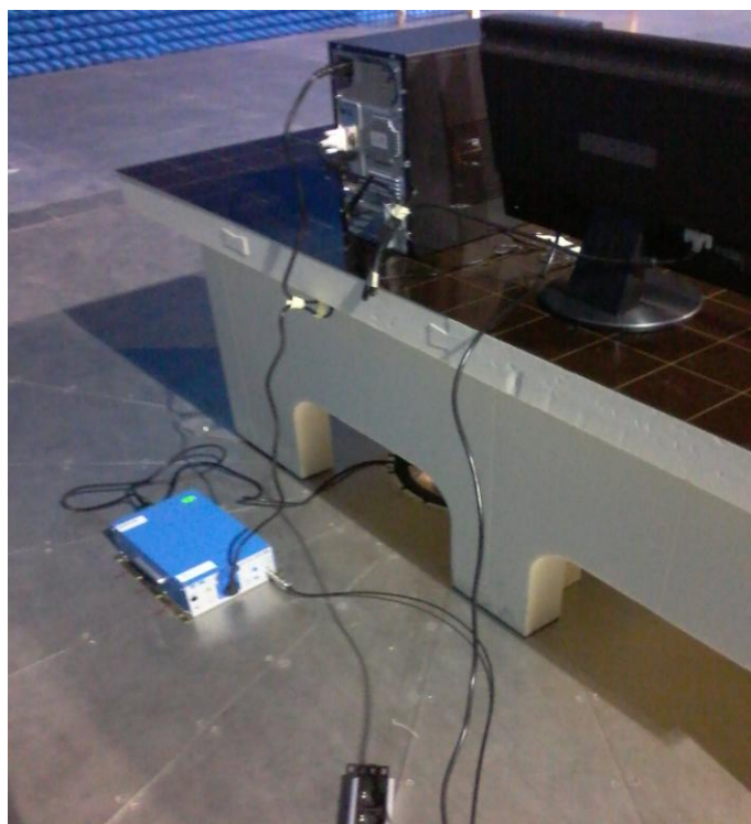
Essai d'émission conduite sur les lignes d'alimentation
