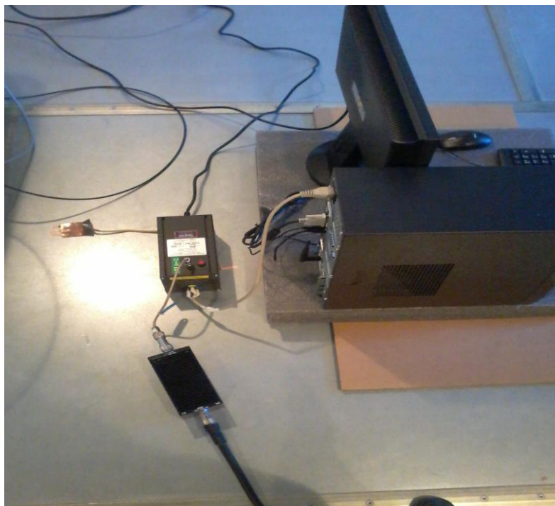
Montage d'essai IEC 61000-4-6 ( Injection sur la ligne AC )
