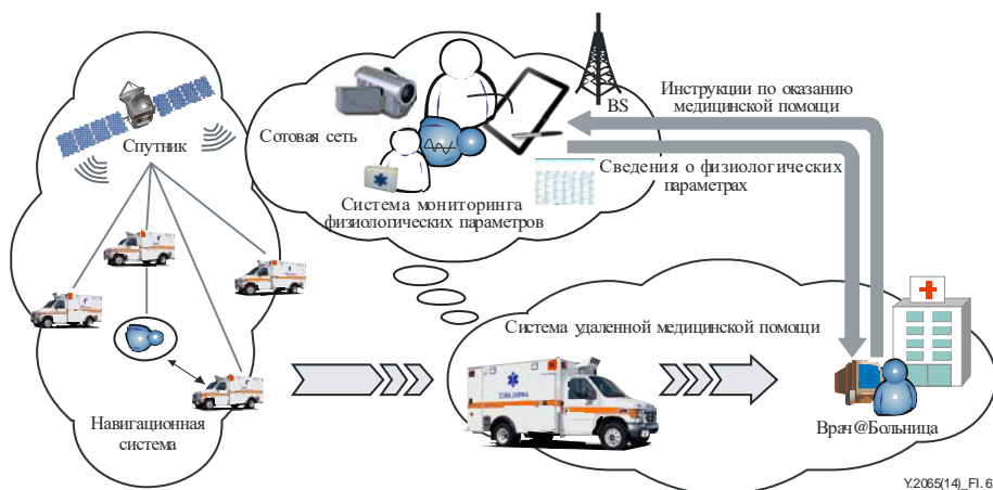
Рисунок I.6 – Основные части системы PEMS
