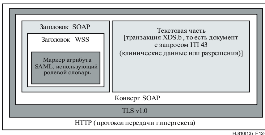
Рисунок 12-9 – Инкапсуляция SAML и общий стек протокола
