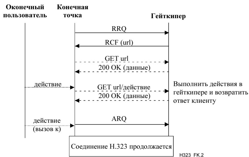
Рисунок К.2/Н.323 – Пример не связанного с соединением управления услугой
