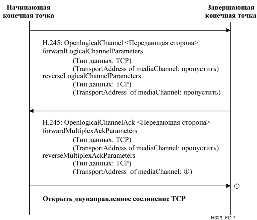
Рисунок D.7/Н.323 – Один двунаправленный канал без быстрого соединения
