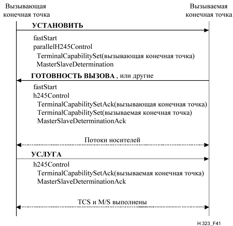
Рисунок 41/Н.323 – Успешный запуск H.245 параллельно с быстрым соединением
