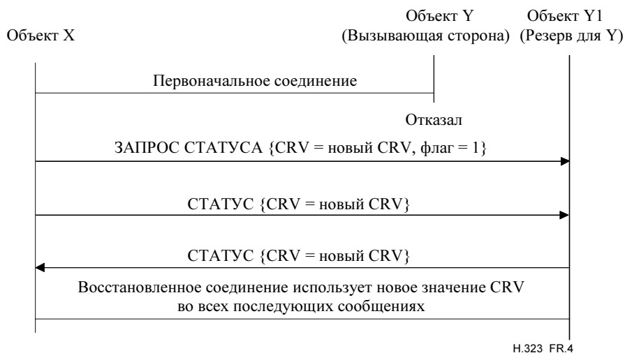
Рисунок R.4/Н.323 – Отказавшее устройство использует метод А и является вызывающей стороной
