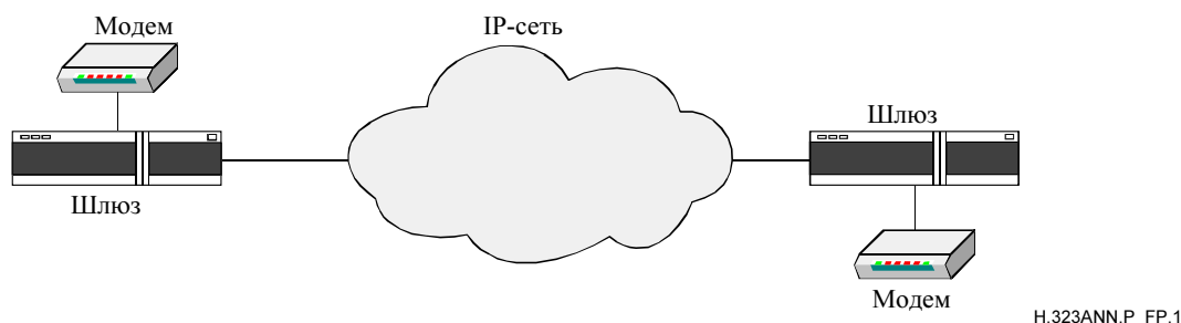
Рисунок Р.1/H.323 – Типовое приложение "модем через IP"
