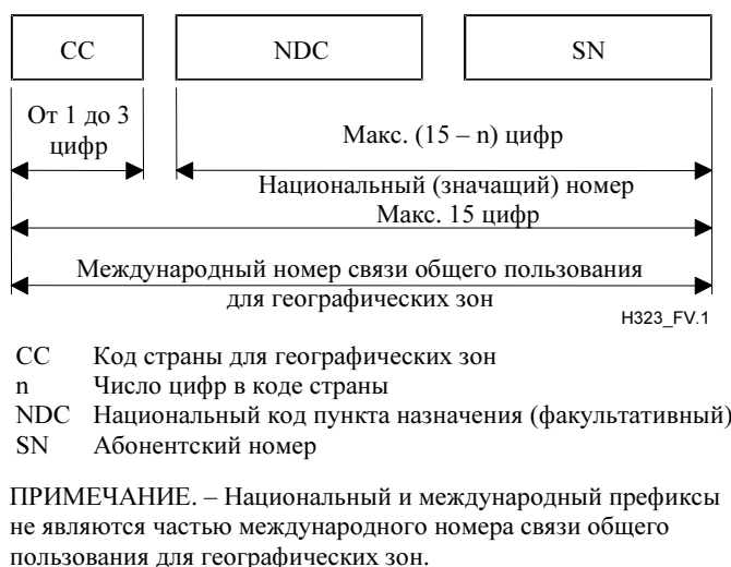
Рисунок V.1/Н.323 – Международная структура номера связи общего пользования для географических зон
