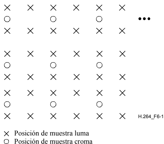
Figura 6-1 – Posiciones vertical y horizontal nominales de muestras luma y croma 4:2:0 en un cuadro
