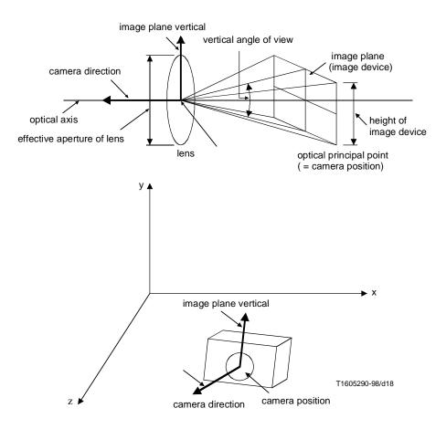
Figure 6-17 -- Camera parameters
