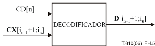
Figura H.5 – Reloj de bits basado en el decodificador aritmético JPEG 2000 Parte 1
