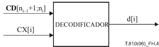
Figura H.4 – Reloj de símbolos basado en el decodificador aritmético JPEG 2000 Parte 1
