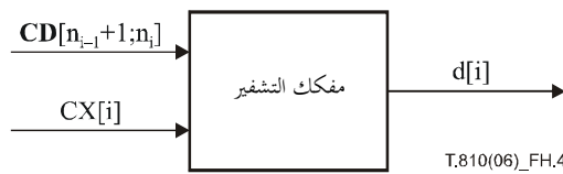
الشكل 4.H - مفكك تشفير حسابي وفقاً للجزء 1 من المعيار JPEG 2000 يعمل استناداً إلى تواتر الرموز
