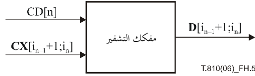
الشكل 5.H – مفكك تشفير حسابي وفقاً للجزء 1 من المعيار JPEG 2000 يعمل استناداً إلى تواتر البتات
