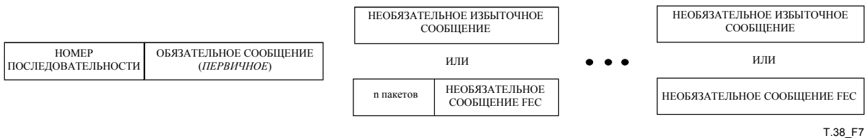
Рисунок 7/Т.38 – Основной формат раздела полезной нагрузки UDPTL (заголовок UDP не показан)
