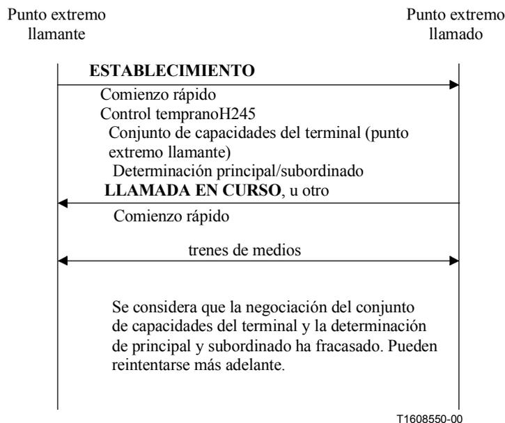
**Figura 42/H.323 – Iniciación H.245 en paralelo con conexión rápida sin éxito**
