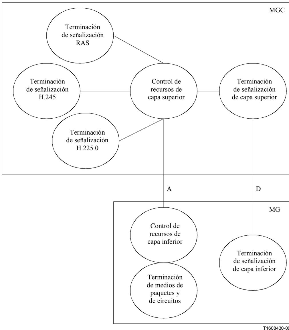
Figura 11/H.323 – SS7 terminada en la MG
