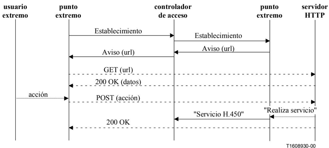
**Figura K.3/H.323 – Ejemplo de control de servicio relacionado con la llamada utilizando una URL en los mensajes de señalización de llamada H.225.0**
