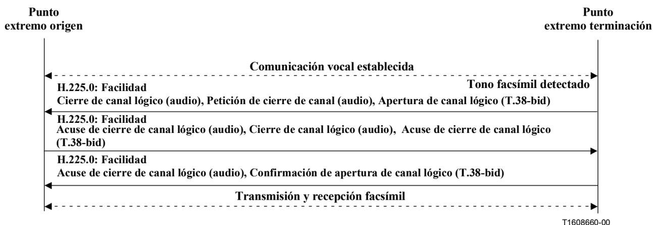
**Figura D.11/H.323 – Transición exitosa de una llamada vocal existente a T.38 utilizando un canal de medios bidireccional (TCP) con tunelización**
