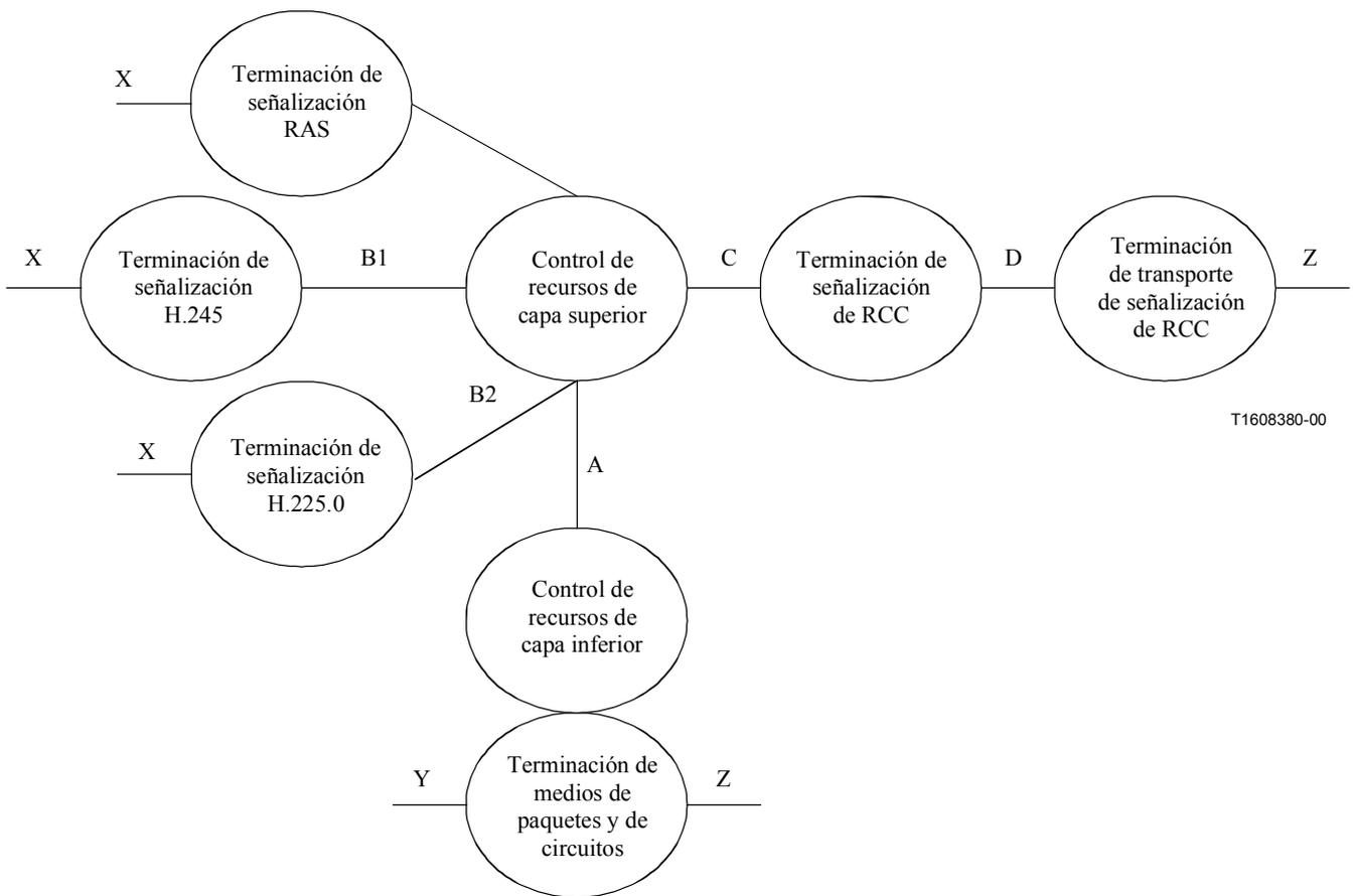
**Figura 6/H.323 – Arquitectura funcional de una pasarela descompuesta**
