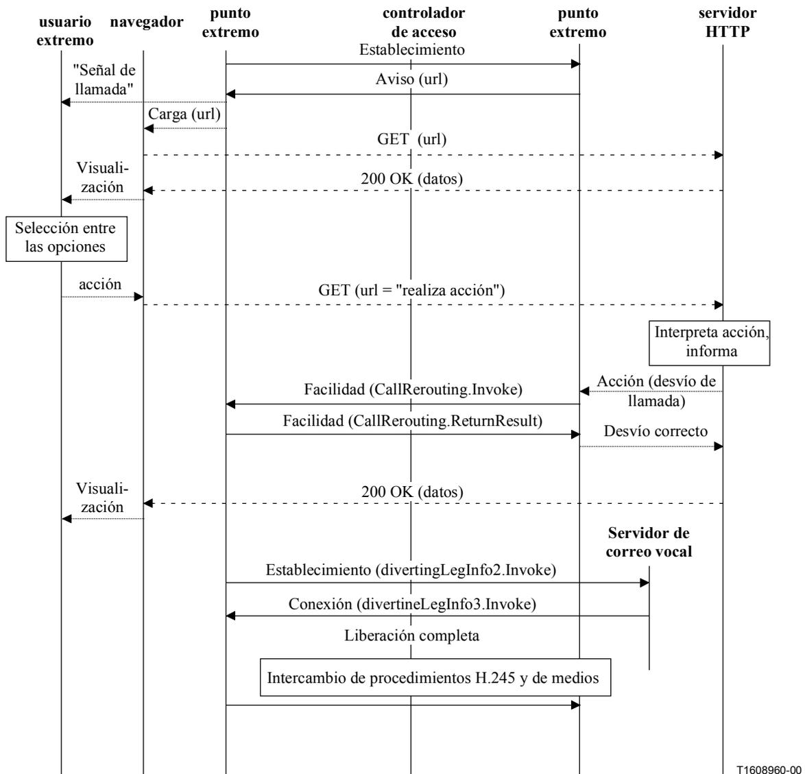
Figura K.6/H.323 – Control de servicio relacionado con la llamada, llamada no encaminada por el controlador de acceso
