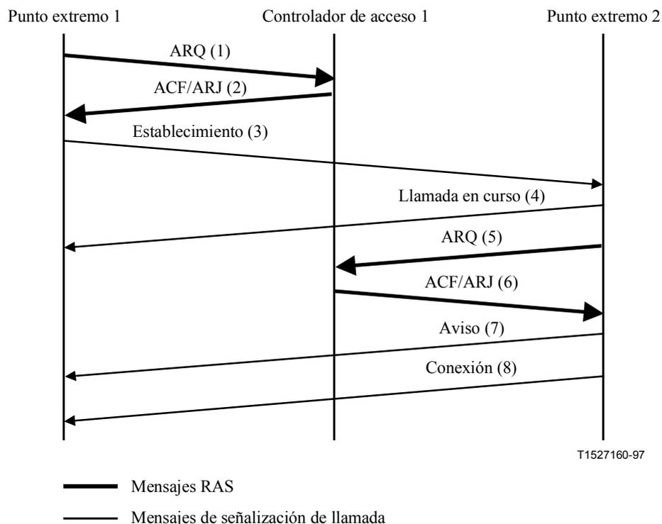
**Figura 30/H.323 – Ambos puntos extremos registrados, el mismo controlador de acceso – Señalización de llamada directa**
