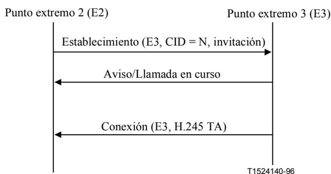
**Figura 45/H.323 – Señalización de invitación con MC**
