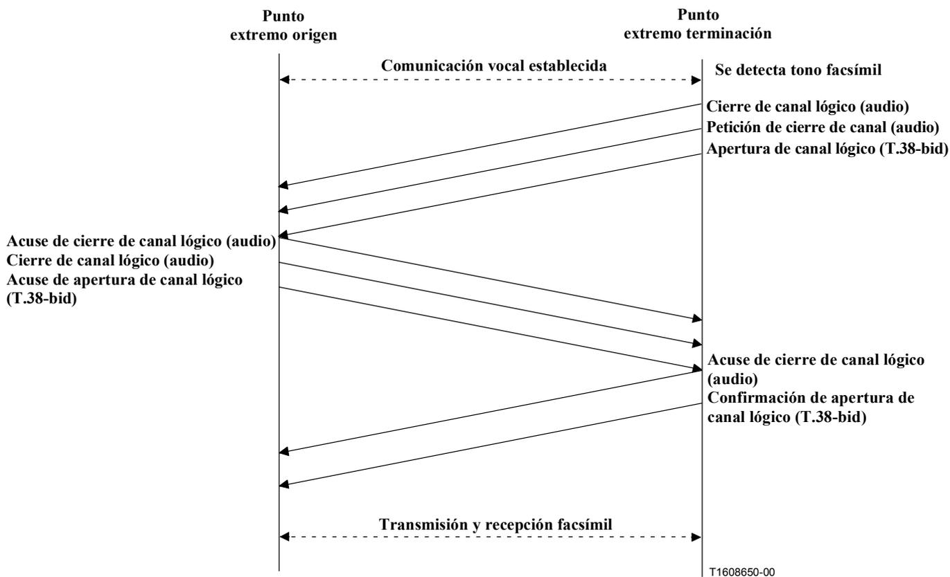
**Figura D.10/H.323 – Transición exitosa de una llamada vocal existente a T.38 utilizando un canal de medios bidireccional (TCP) sin tunelización**
