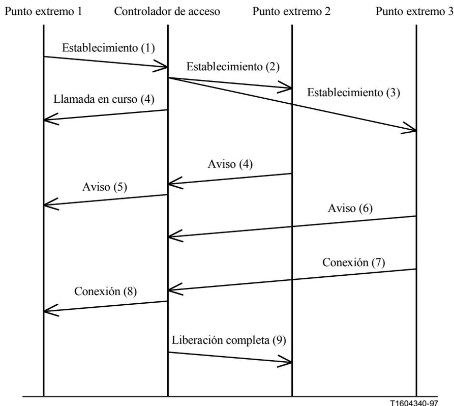
**Figura III.2/H.323 – Ejemplo de localización de usuario utilizando señalización H.225.0/Q.931 (por razones de claridad no se muestra la señalización RAS)**
