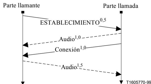
**Figura E.23/H.323 – Flujo de información para el establecimiento de comunicación basado en UDP**
