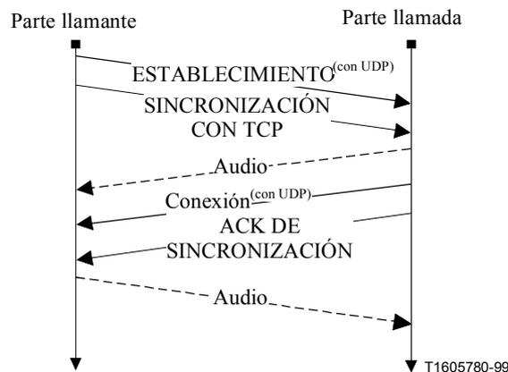
**Figura E.24/H.323 – Flujo de información para el procedimiento mixto TCP y UDP**
