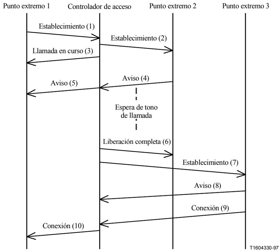
**Figura III.1/H.323 – Ejemplo de localización de usuario utilizando señalización H.225.0/Q.931 (por razones de claridad no se muestra la señalización RAS)**
