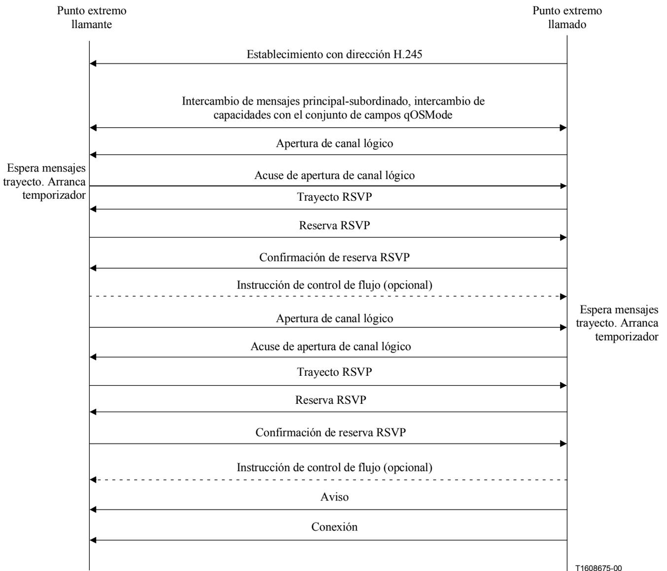
**Figura II.5/H.323 – Sincronización de RSVP cuando no se utiliza la conexión rápida**
