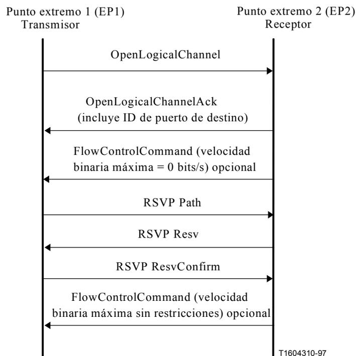
**Figura II.3/H.323 – Secuencia de mensajes para abrir un canal lógico unidifusión con RSVP**
