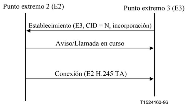
**Figura 47/H.323 – Señalización de incorporación con MC**
