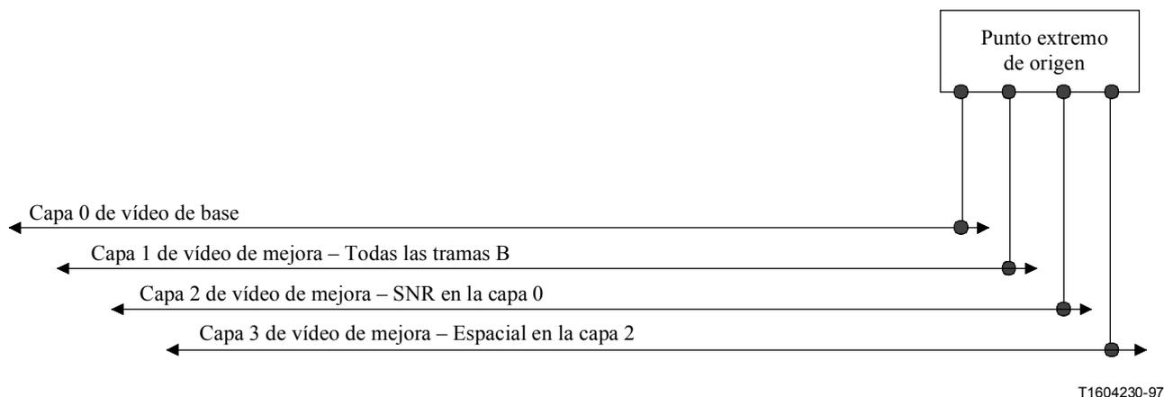
**Figura B.1/H.323 – Modelo con video por capas**
