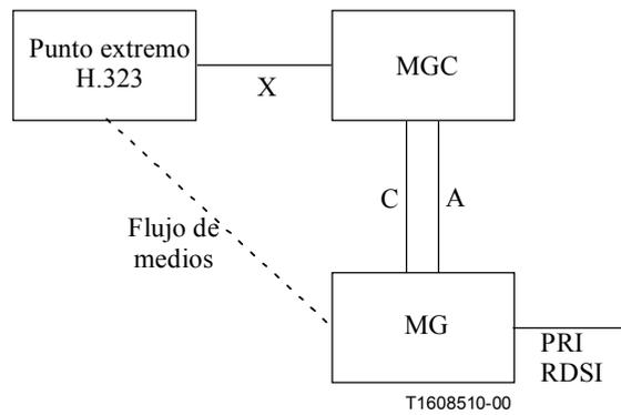
**Figura 19/H.323 – Pasarela descompuesta y punto extremo H.323**
