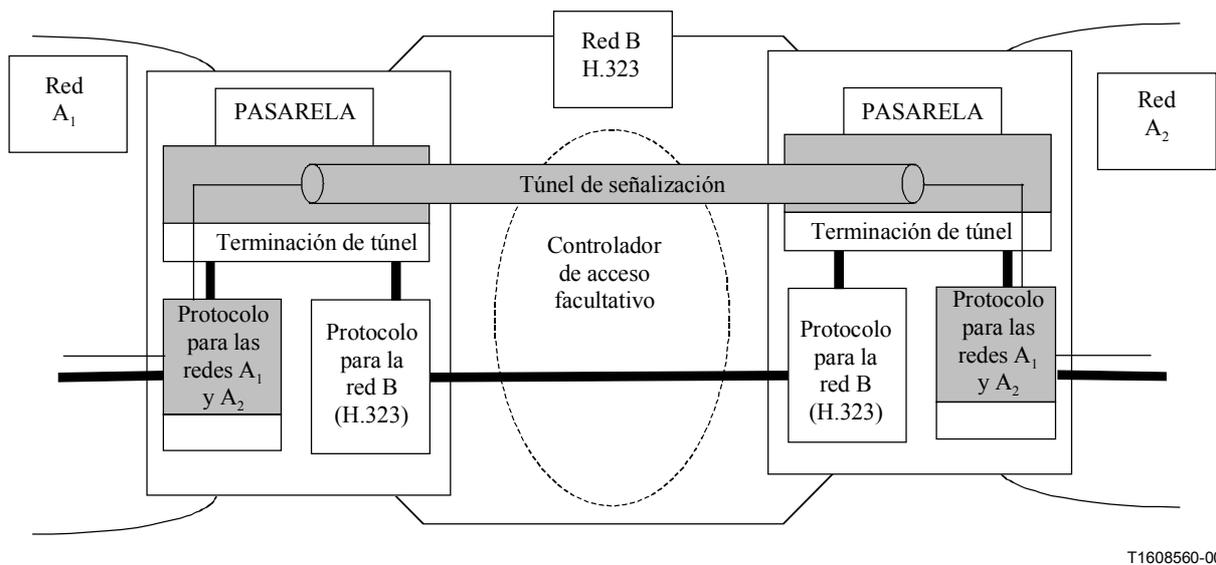
**Figura 53/H.323 – Tunelización de señalización entre pasarelas**
