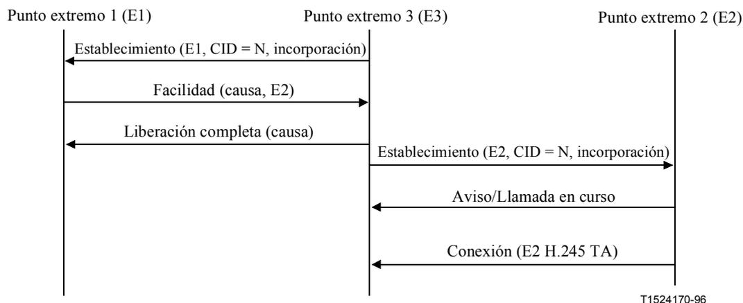
**Figura 48/H.323 – Señalización de incorporación sin MC**
