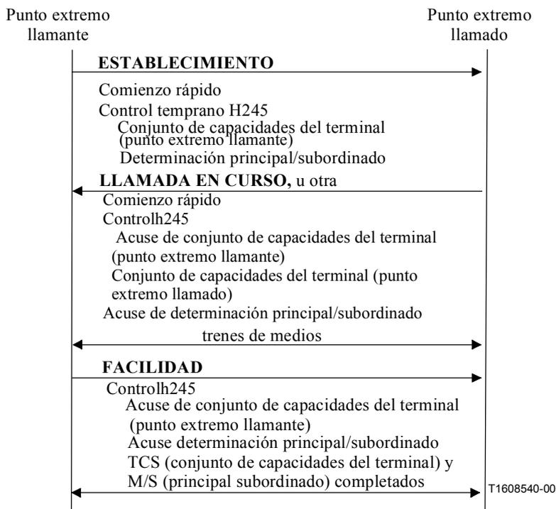
**Figura 41/H.323 – Iniciación H.245 en paralelo con conexión rápida exitoso**
