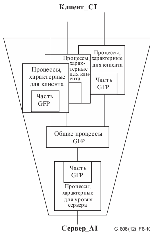
Рисунок 8-10 – Общие блоки адаптации сервер/клиент на основе GFP
