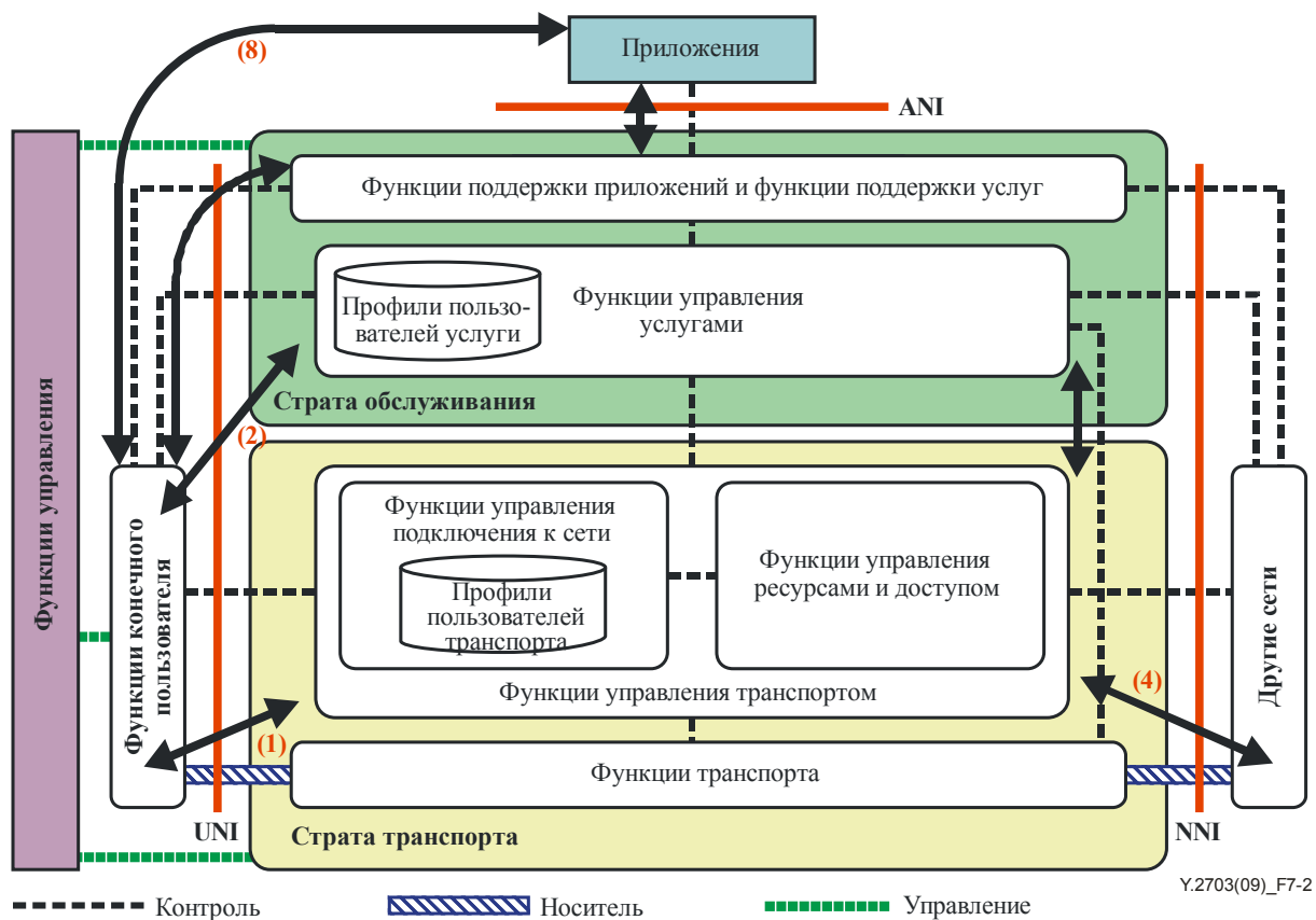
Рисунок 7-2 – Архитектура СПП и соответствующие домены AAA (Y.2702 "Аутентификация в СПП")
