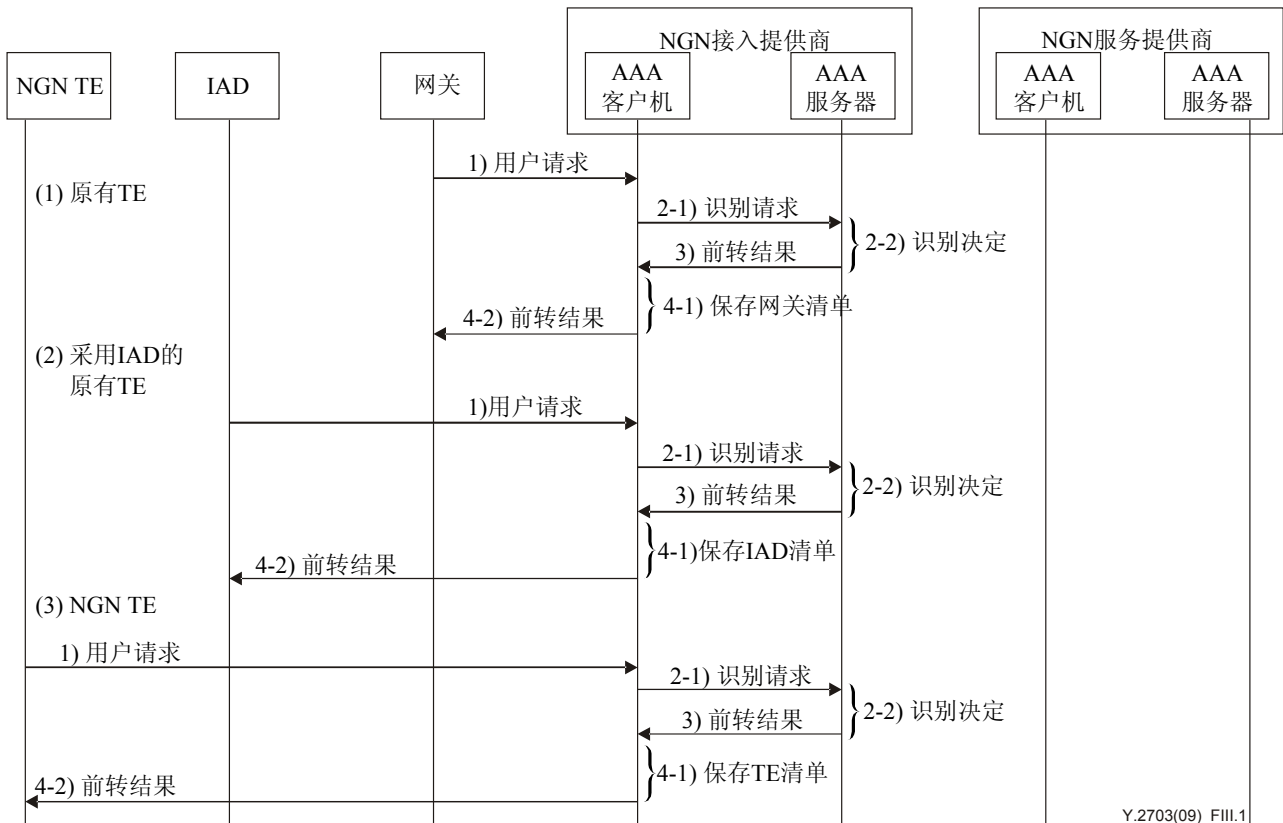
图III.1 – 接入NGN网络的设备识别程序
