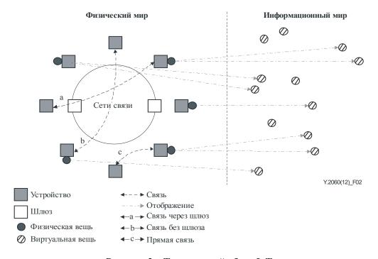
Рисунок 2 – Технический обзор ІоТ
