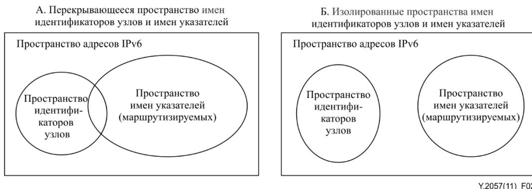
**Рисунок 2 – Пространства имен идентификаторов узлов и указателей в пространстве адресов IPv6**
