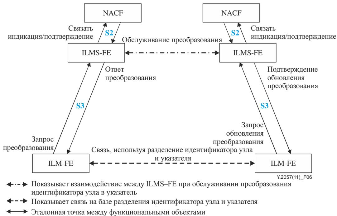
**Рисунок 6 – Архитектурные компоненты разделения идентификатора узла и указателя в СПП**
