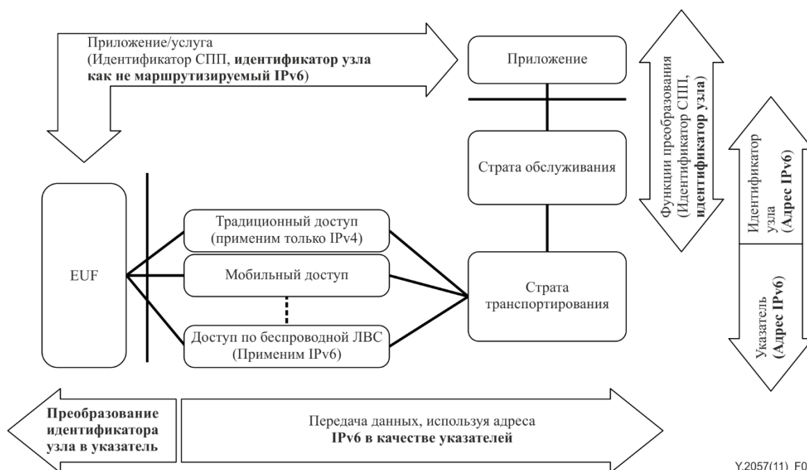
Рисунок 7 – Общая архитектура разделения идентификатора узла и указателя – идентификатор узла как немаршрутизируемый адрес IPv6 и указатель как адрес IPv6
