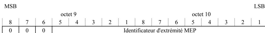
**Figure 9.2-3/Y.1731 – Format d'identificateur d'extrémité MEP dans l'unité PDU de message CCM**
