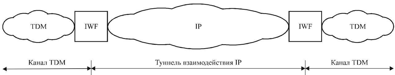
Рисунок 6-2/Y.1453 – Функциональная архитектура взаимодействия TDM и IP, изображенная с использованием схематических соглашений Рекомендации МСЭ-Т G.809
