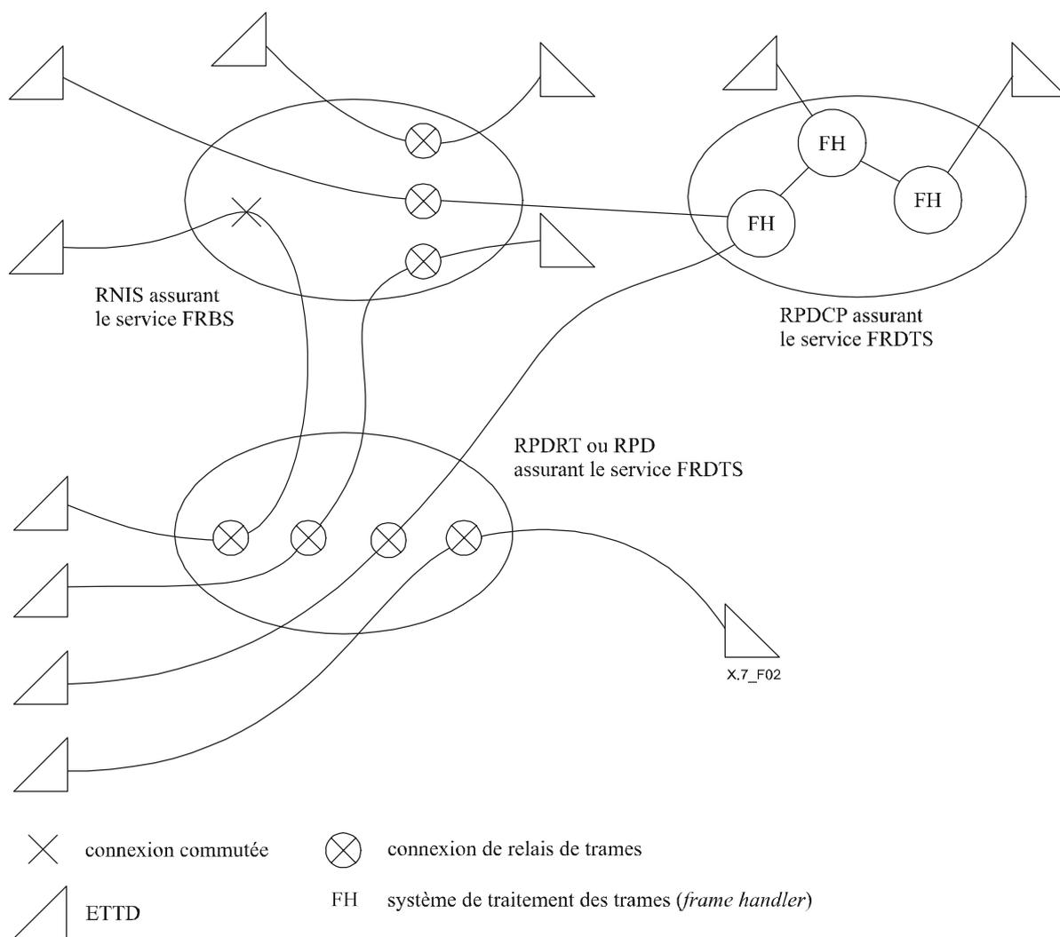
**Figure 2/X.7 – Divers réseaux assurant le service de transmission de données à relais de trames (FRDTS) et le service support à relais de trames (FRBS)**
