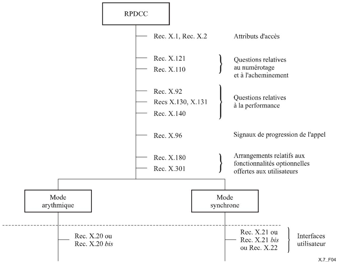
**Figure 4/X.7 – Recommandations de la série X portant sur les caractéristiques techniques des services de transmission de données à commutation de circuits dans les RPDCC**
