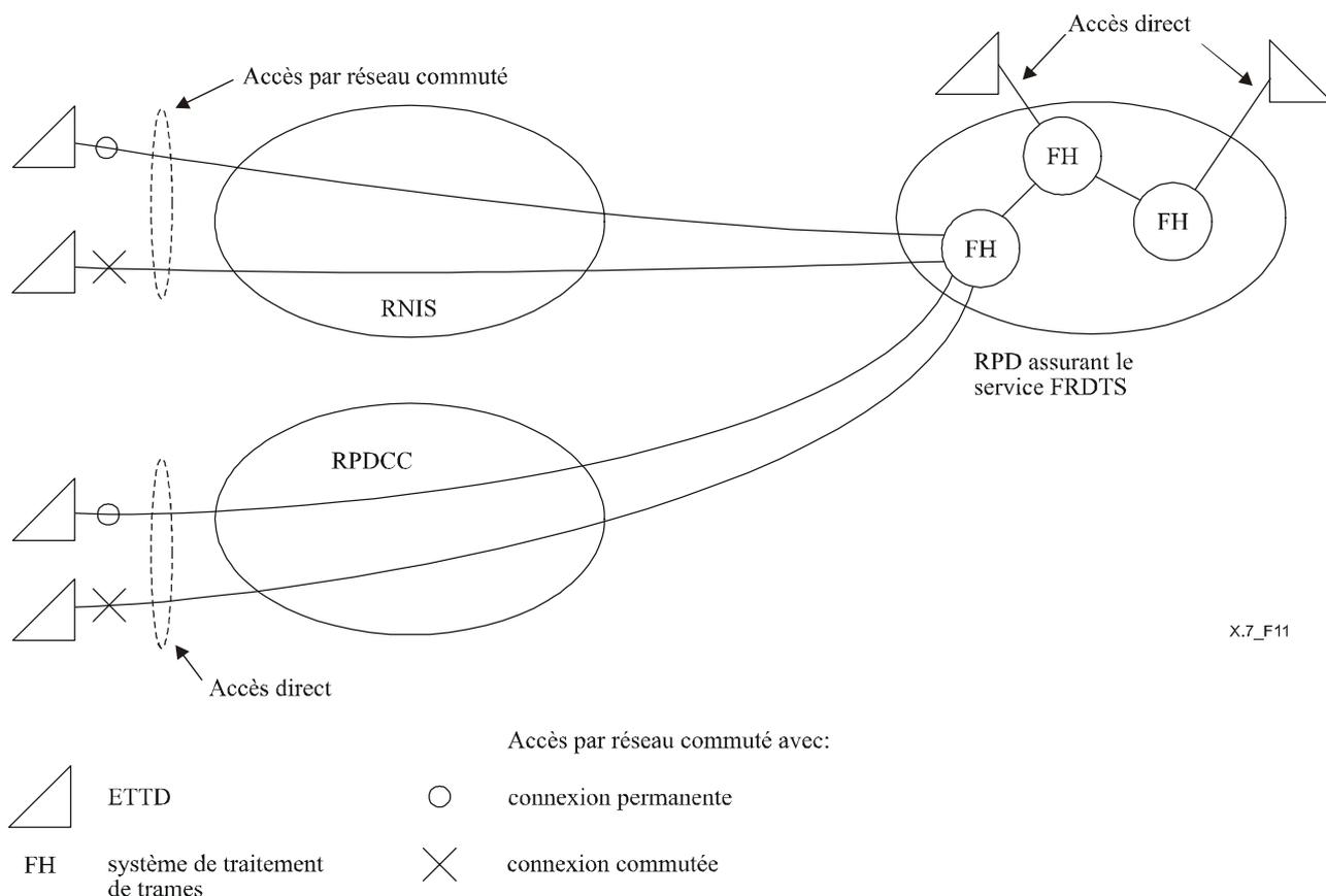
**Figure 11/X.7 – Mécanismes d'accès des services de transmission de données à relais de trames**
