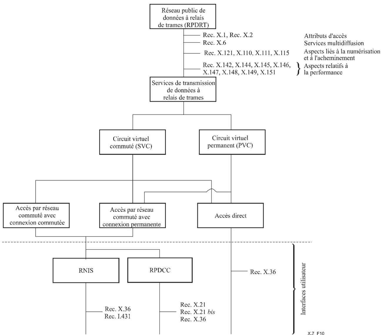
**Figure 10/X.7 – Recommandations sur les caractéristiques techniques de transmission de données à relais de trames d'un RPDRT**
