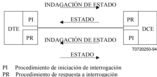
Figura 11-7/X.36 – Principios del procedimiento bidireccional
