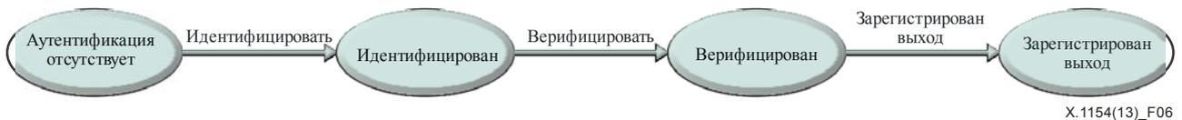
**Рисунок 6 – Переход состояний однофакторной аутентификации**
