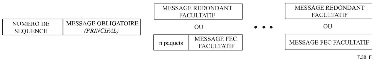
**Figure 7/T.38 – Format de base de la section de charge utile UDPTL (en-tête UDP non représenté)**
