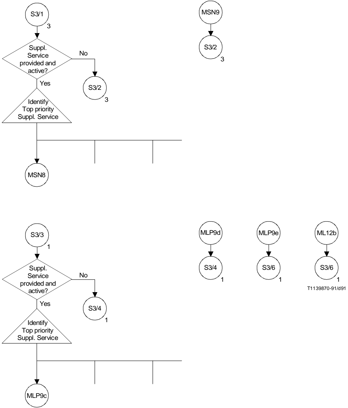
FIGURA A.3/Q.71 (hoja 5 de 7) CC (FE3) – Interfuncionamiento con los servicios suplementarios
