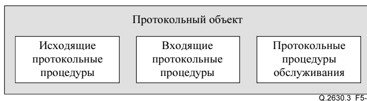
Рисунок 5-2/Q.2630.3 – Внутренняя структура протокольного объекта сигнализации AAL типа 2
