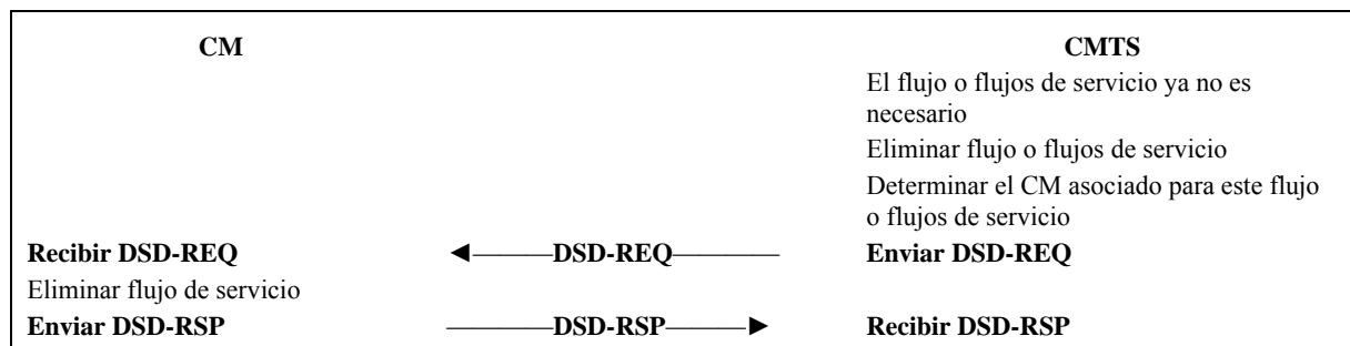
Figura B.11-51/J.112 – Eliminación de servicio dinámica iniciada por el CMTS
