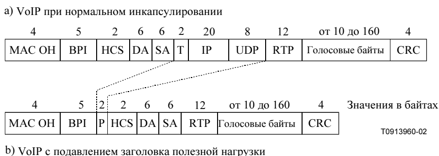
Рисунок С.10-15/Ј.112 – Пример подавления заголовка полезной нагрузки для прямого потока
