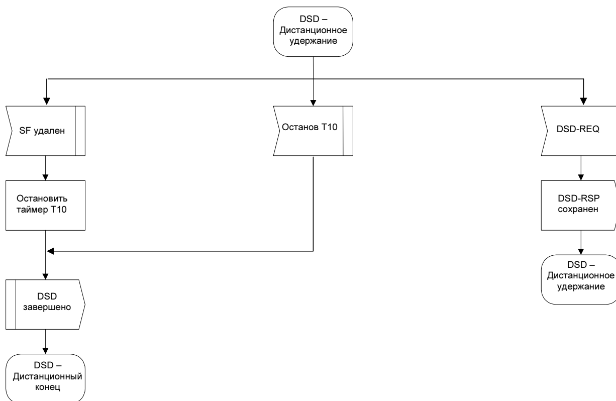
Рисунок С.11-56/J.112 – DSD – Диаграмма последовательности операций для состояния удержания при дистанционно инициируемой транзакции
