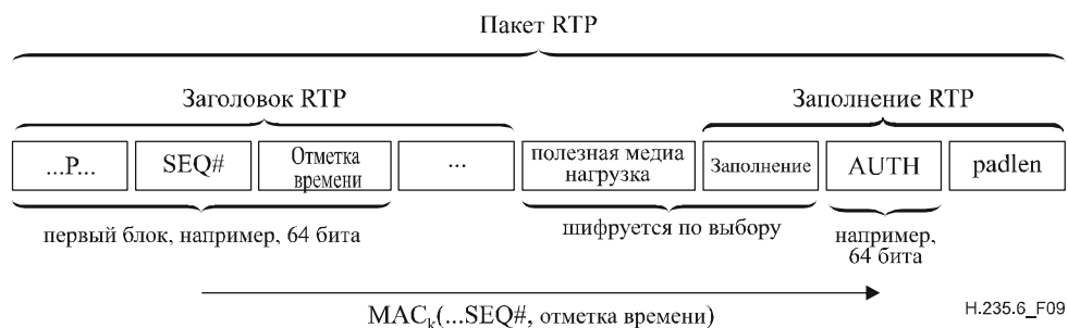
Рисунок 9/Н.235.6 – Формат пакетов RTP для защиты от спама медийной информации
