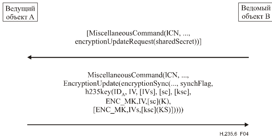
Рисунок 4/Н.235.6 – Обновление и распределение неквитированного сеансового ключа от ведущего объекта к ведомому(ым)
