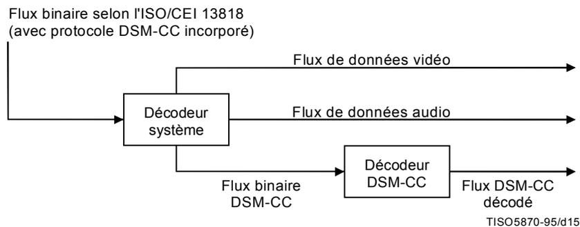
**Figure B.3 – Flux de commande DSM-CC décodé sous forme d'élément du flux système**
