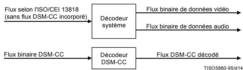
Figure B.2 – Flux de commande DSM-CC décodé sous forme de flux binaire autonome
