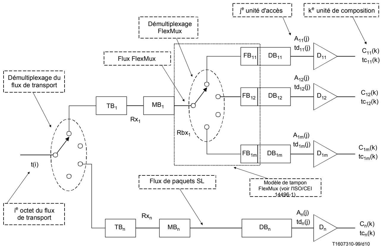
Figure 2-5 – Modèle T-STD utilisé pour le contenu ISO/CEI 14496
