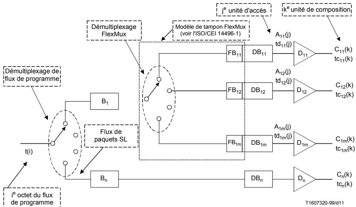
**Figure 2-6 – Modèle P-STD pour l'ISO/CEI 14496 dans un flux de programme**
