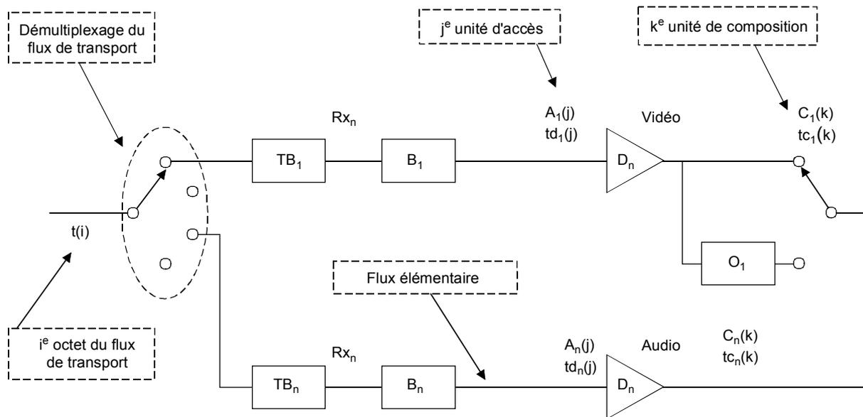
Figure 2-4 – Extensions du modèle T-STD pour les flux élémentaires distincts ISO/CEI 14496
