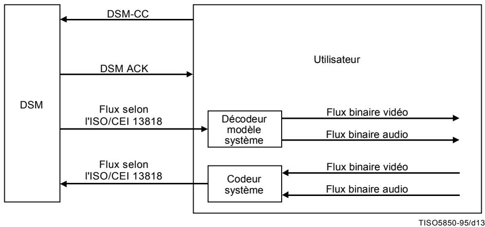
Figure B.1 – Configuration d'une application de commande et DSM-CC
