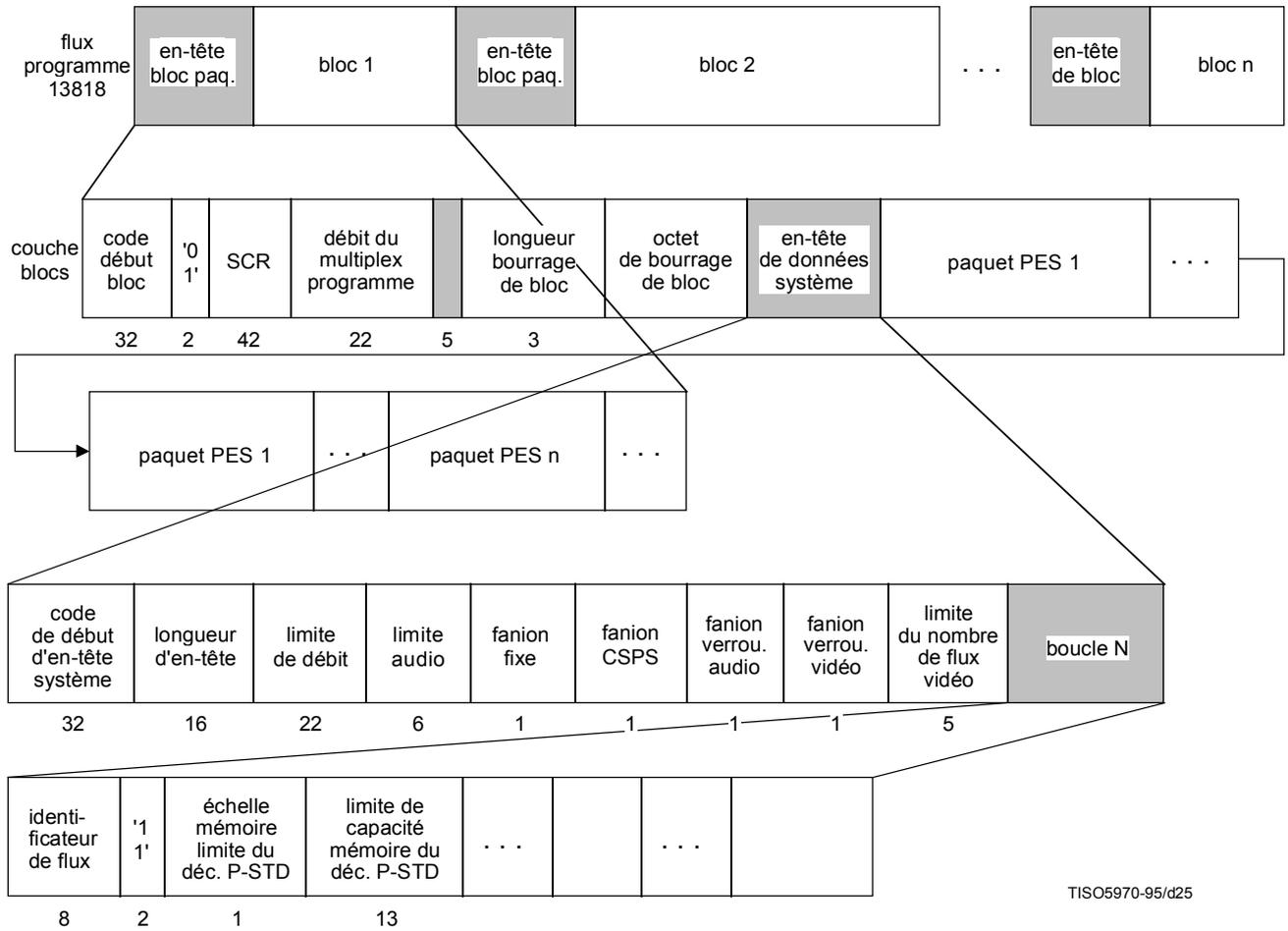
Figure F.7 – Diagramme du flux de programme
