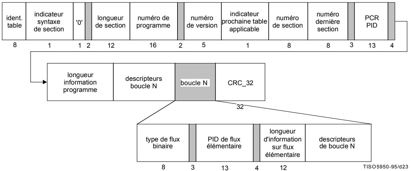
**Figure F.5 – Diagramme de section de table de mappage de progamme pour flux de transport**
