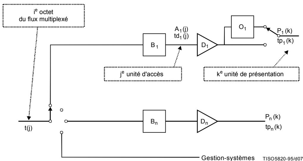
Figure 2-2 – Notation d'un décodeur modèle de système pour un flux de programme
