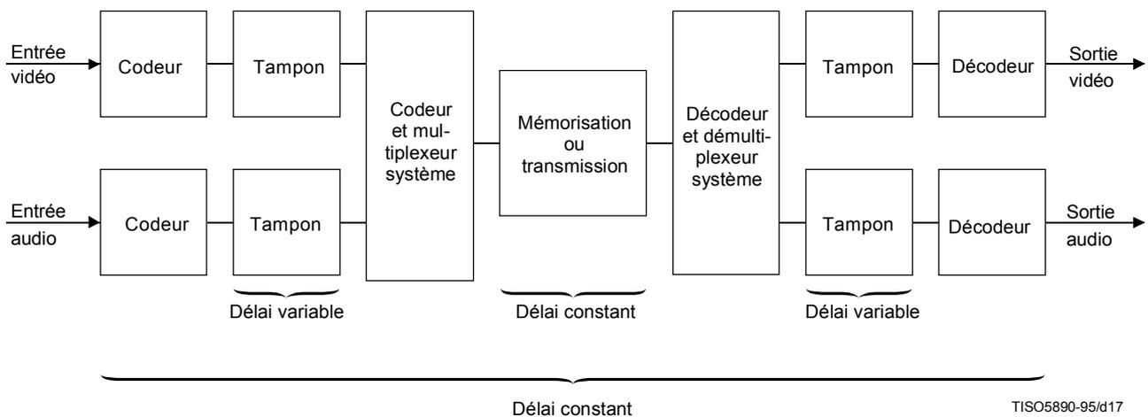
**Figure D.1 – Modèle à délai constant**
