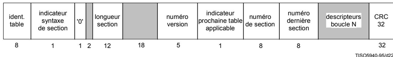
**Figure F.4 – Diagramme de section de table d'accès conditionnel**
