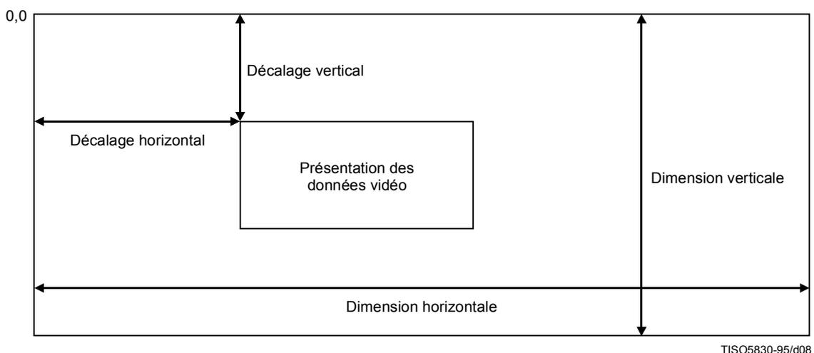
**Figure 2-3 – Zone d'affichage par descripteur de la grille de fond réceptrice**
