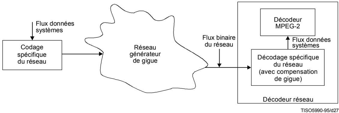
Figure J.1 – Envoi de flux systèmes sur un réseau générateur de gigue
