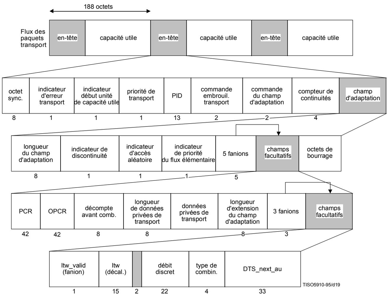
Figure F.1 – Diagramme syntaxique du flux de transport
