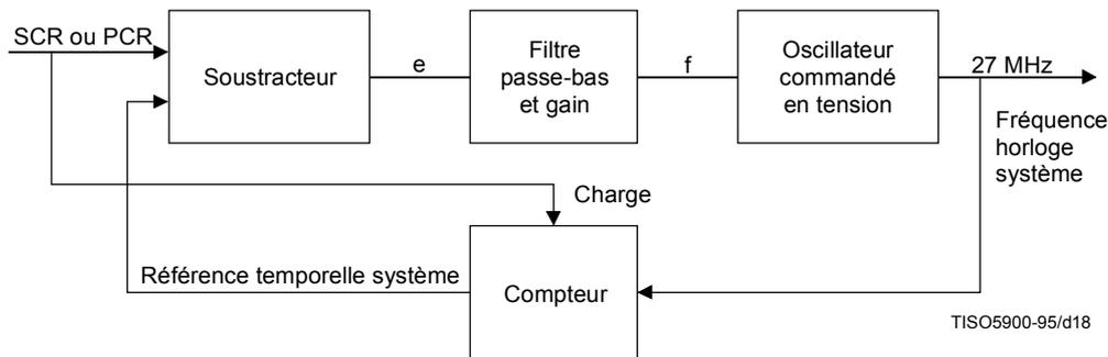
Figure D.2 – Recalage d'horloge STC par verrouillage de phase (PLL)
