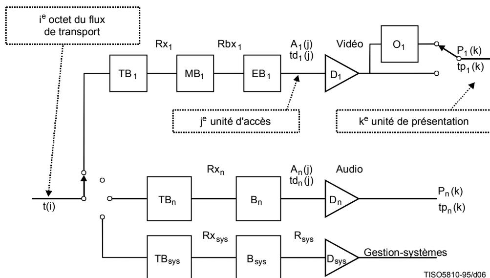
Figure 2-1 – Notation d'un décodeur modèle de système pour un flux de transport
