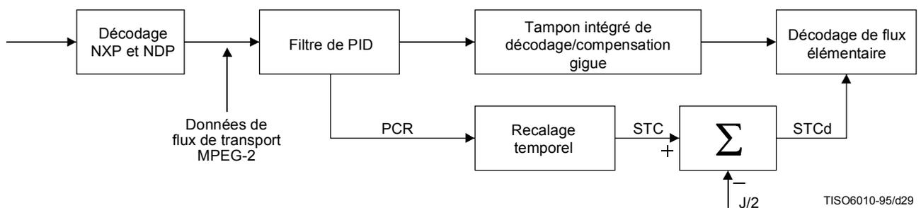
Figure J.3 – Fonctions intégrées de lissage de gigue et de décodage MPEG-2
