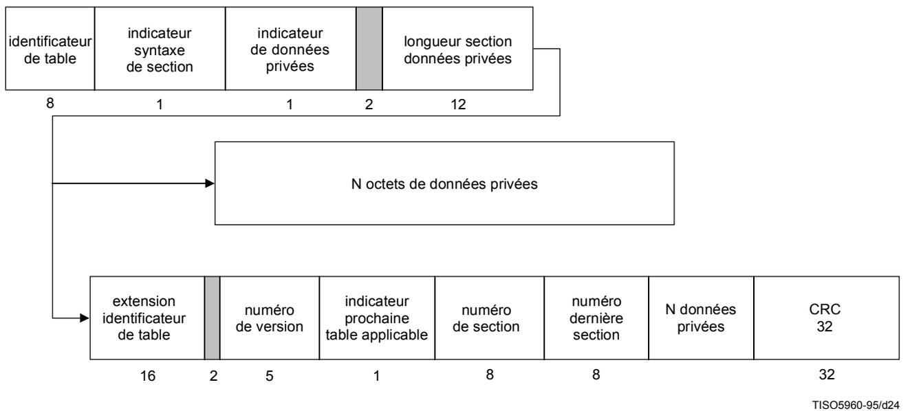
**Figure F.6 – Diagramme de section de table de données privées**
