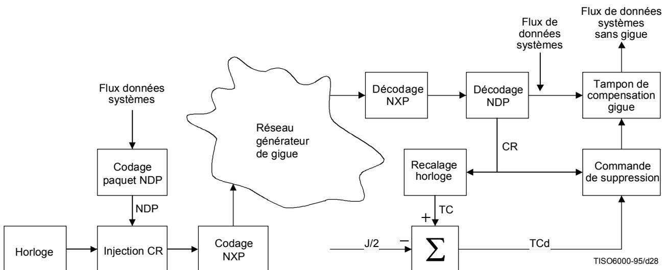
Figure J.2 – Lissage de gigue au moyen de pointeurs temporels issus de la couche Réseau
