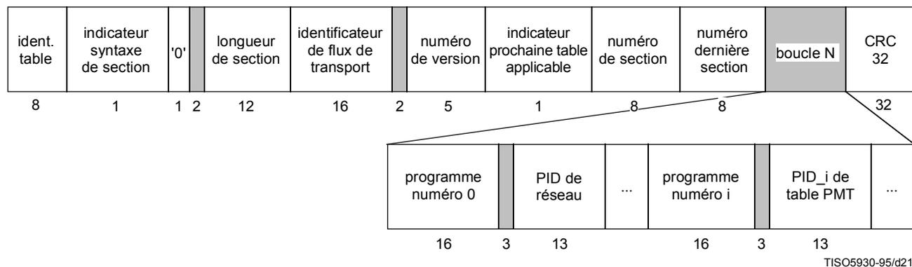
**Figure F.3 – Diagramme de section de table d'association de programmes**
