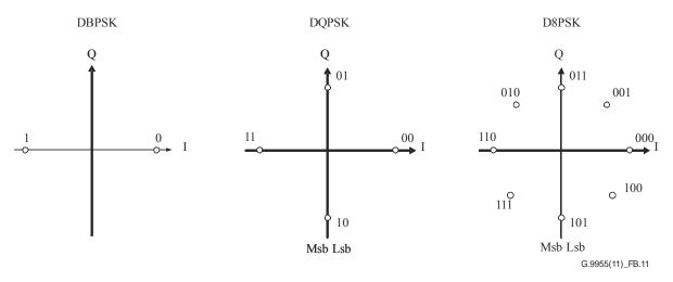
Figure B.11 – DBPSK, DQPSK and D8PSK mapping
