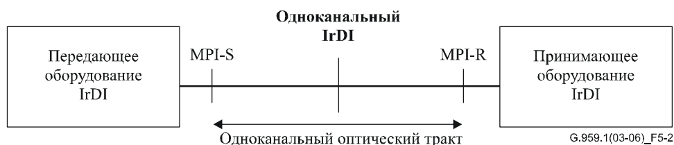
Рисунок 5-2/G.959.1 – Одноканальная эталонная конфигурация IrDI
