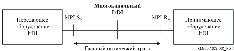
Рисунок 5-1/G.959.1 – Многоканальная эталонная конфигурация IrDI
