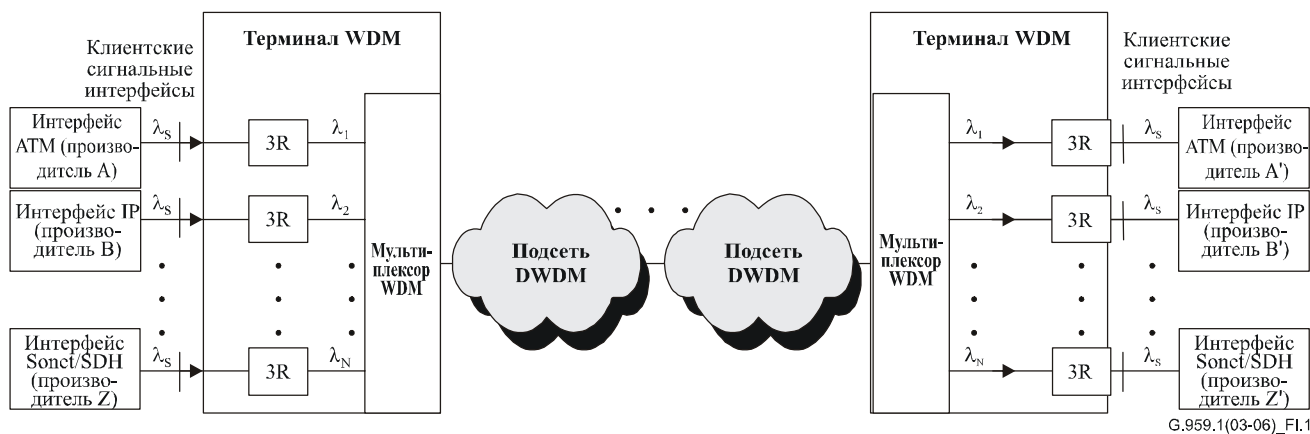
Рисунок I.1/G.959.1 – Пример клиентского сигнального интерфейса с регенерацией 3R
