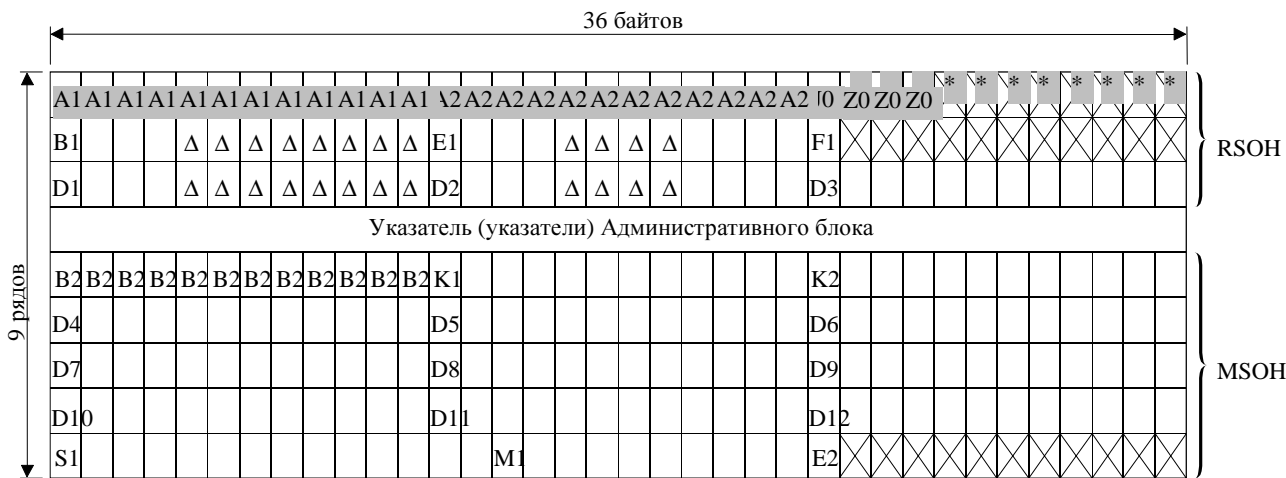
Рисунок 9-3/G.707/Y.1322 – Предзаголовок SOH модуля STM-1
