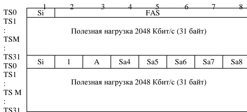
Рисунок 12-2/G.705 – Структура заголовка базового цикла сигнала P12s_CI_D
