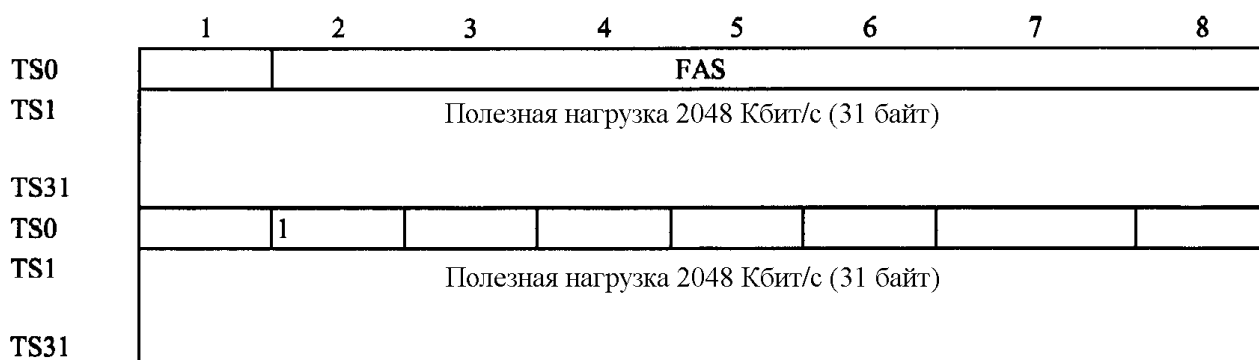
Рисунок 9-8/G.705 – Декодированный E12/P12s_AI_D (без сверхцикла CRC-4)
