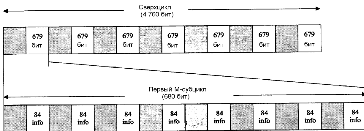
Рисунок 14-3/G.705 – Сигнал P32e_AI_D
