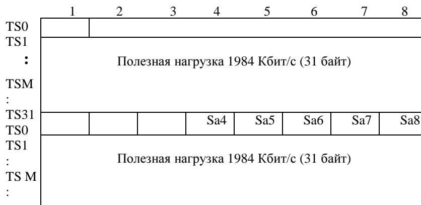
Рисунок 12-17/G.705 – Сигнал P0G32_AI_D/M для P0G32/P0_A_So
