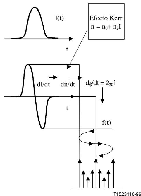
**Figura II.3-6/G.663 – Mecanismo de ensanchamiento espectral debido a automodulación de fase**
