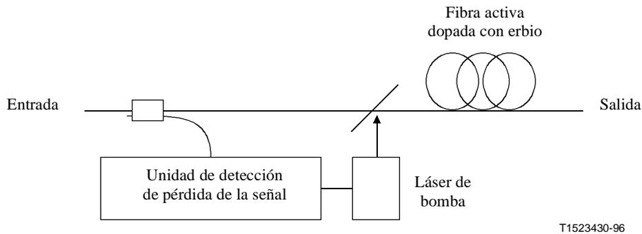
**Figura II.6-2/G.663 – Ejemplo de un sistema de prevención de ondas de choque ópticas**
