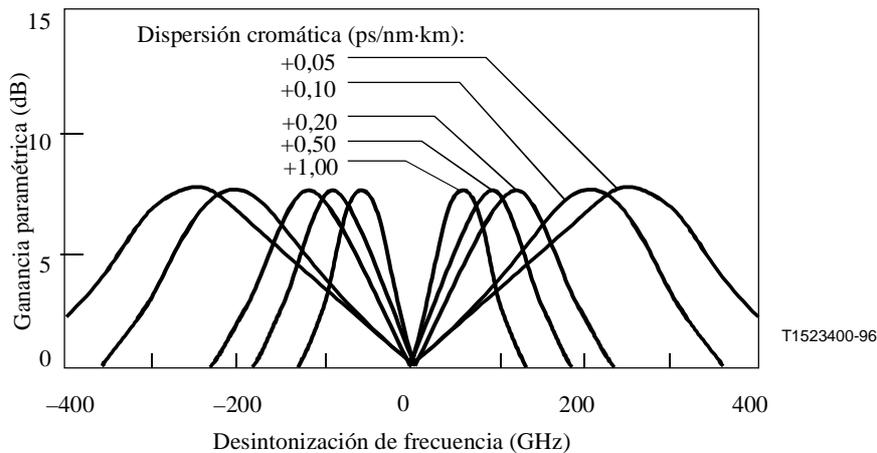
**Figura II.3-5/G.663 – Característica de ganancia MI calculada – desintonización de frecuencia, de fibras de 30 km de largo (pérdida de 0,24 dB/km), con cinco valores diferentes del coeficiente de dispersión, para una potencia inyectada de señal CW de +16 dBm**
