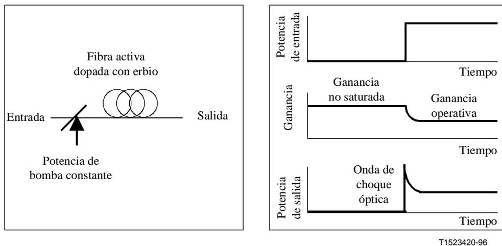
Figura II.6-1/G.663 – Ejemplo de generación de una onda de choque óptica
