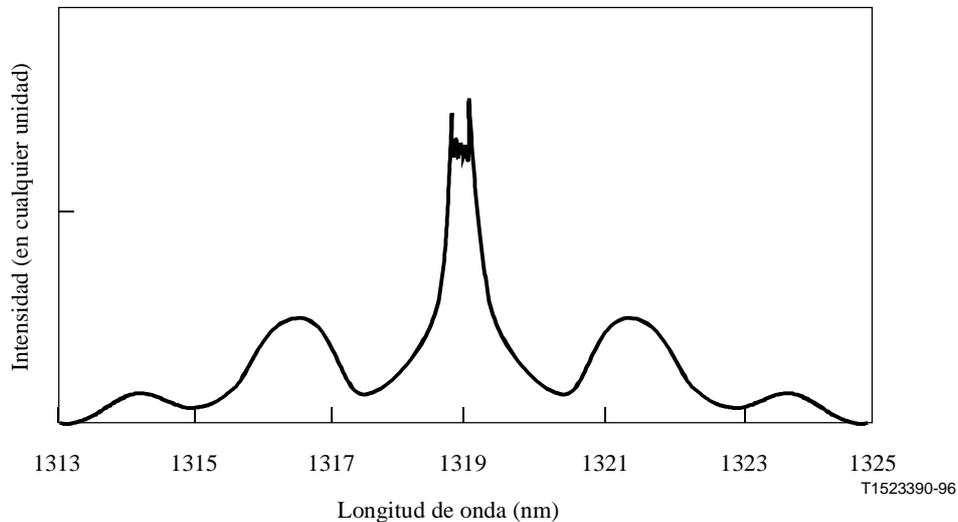
**Figura II.3-4/G.663 – Espectro de potencia de un impulso tras una propagación a lo largo de una fibra de 1 km (anchura de impulso de entrada: 100 ps, potencia de punta: 7 W). Aparecen lóbulos espectrales debidos a la inestabilidad de la modulación**
