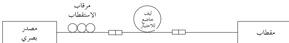
الشكل G.650.2/4 - مخطط لقياس تشتت PMD لتحليل حالة استقطاب
