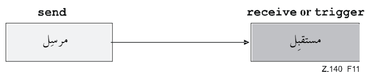
الشكل Z.140/11 - توضيح لا تزامن send و receive
