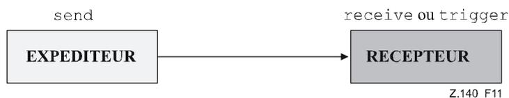
Figure 11/Z.140 – Illustration de l'envoi et de la réception en mode asynchrone
