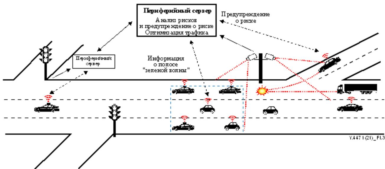
Рисунок 1.3 – Сценарий использования координации между транспортным средством и дорогой
