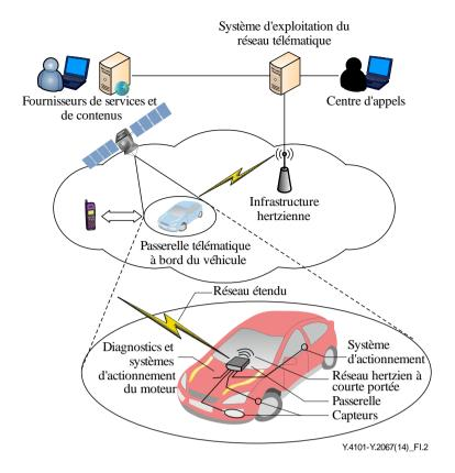
Figure I.2 – Cas d'utilisation d'une passerelle utilisée dans la télématique automobile
