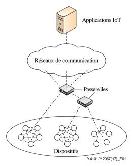
Figure 1 – Scénario type de déploiement de passerelles pour les applications IoT
