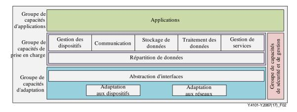
Figure 2 – Cadre technique de référence d'une passerelle pour les applications IoT
