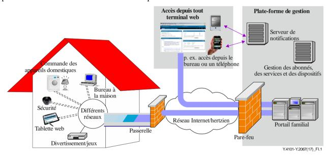
Figure I.1 – Cas d'utilisation d'une passerelle utilisée dans des services domestiques
