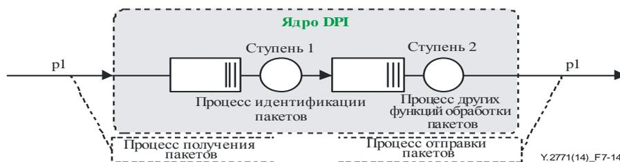
**Рисунок 7-14. Модель трафика ядра DPI: расширение до двухступенчатого тракта передачи пакетов**
