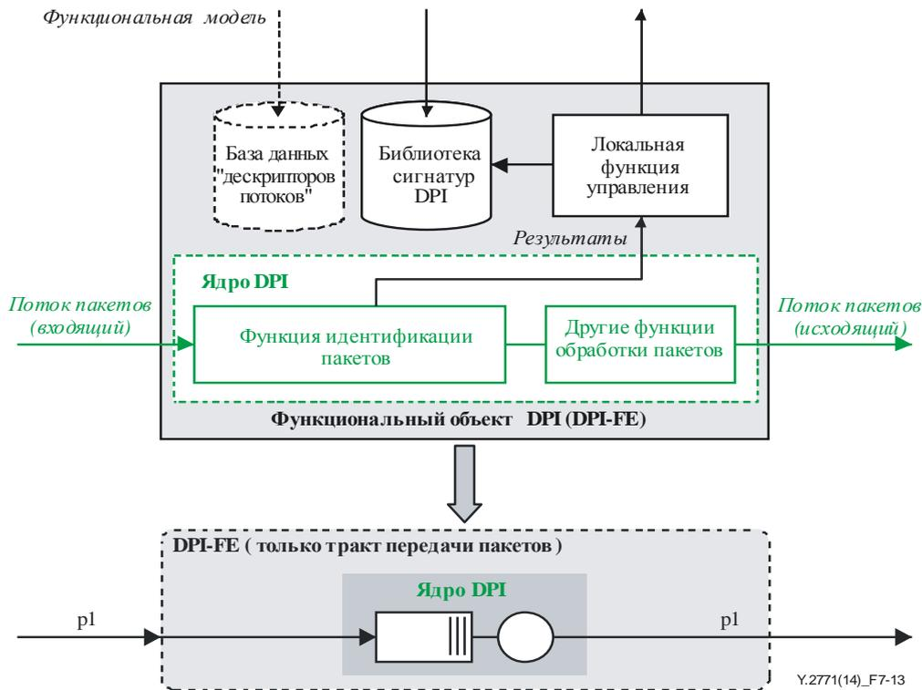
**Рисунок 7-13. Базовая модель трафика DPI-FE с областью действий ядра DPI**
