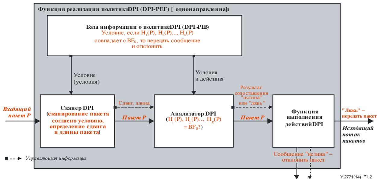
Рисунок I-2. Функциональная модель вероятностной DPI на основе фильтра Блума
