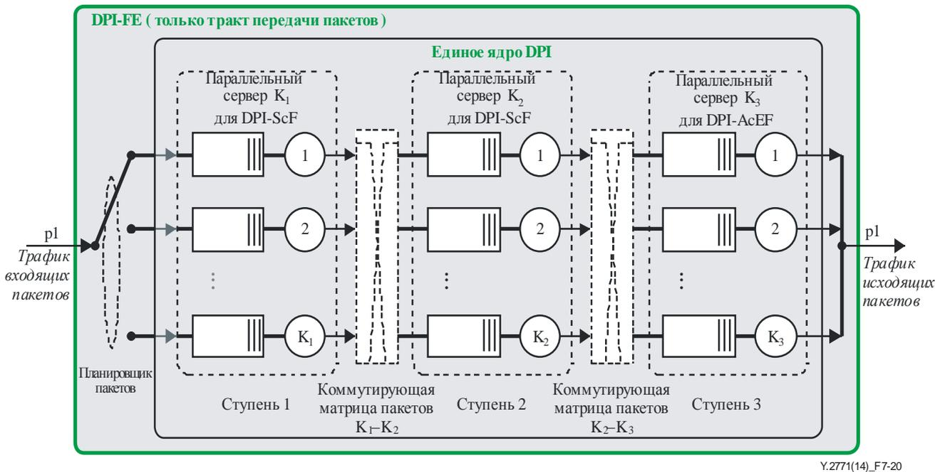
**Рисунок 7-20. Единое ядро DPI на базе трех ступеней и внутреннего параллелизма (единый внешний интерфейс)**
