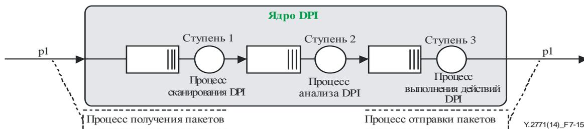
**Рисунок 7-15. Модель трафика ядра DPI: расширение до трехступенчатого тракта передачи пакетов**
