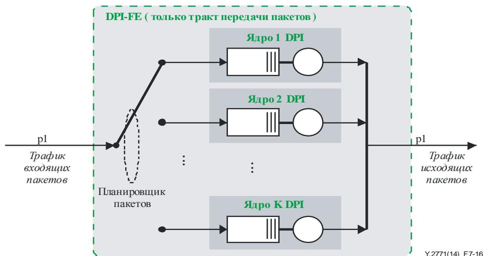
**Рисунок 7-16. Ядра DPI – единый внешний интерфейс и внутренний параллелизм**
