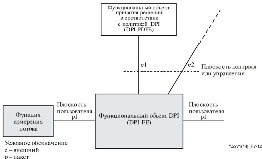
**Рисунок 7-12. Удаленная функция измерения потока**
