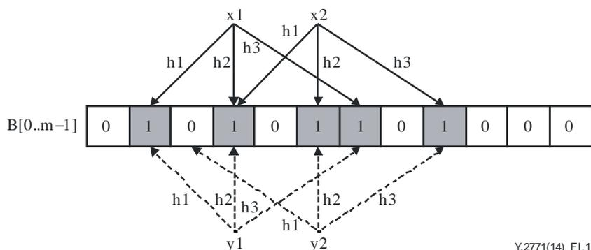
Рисунок I-1. Программирование и запрос фильтра Блума (BF равен битовому вектору  $B[0..m-1]$ )
