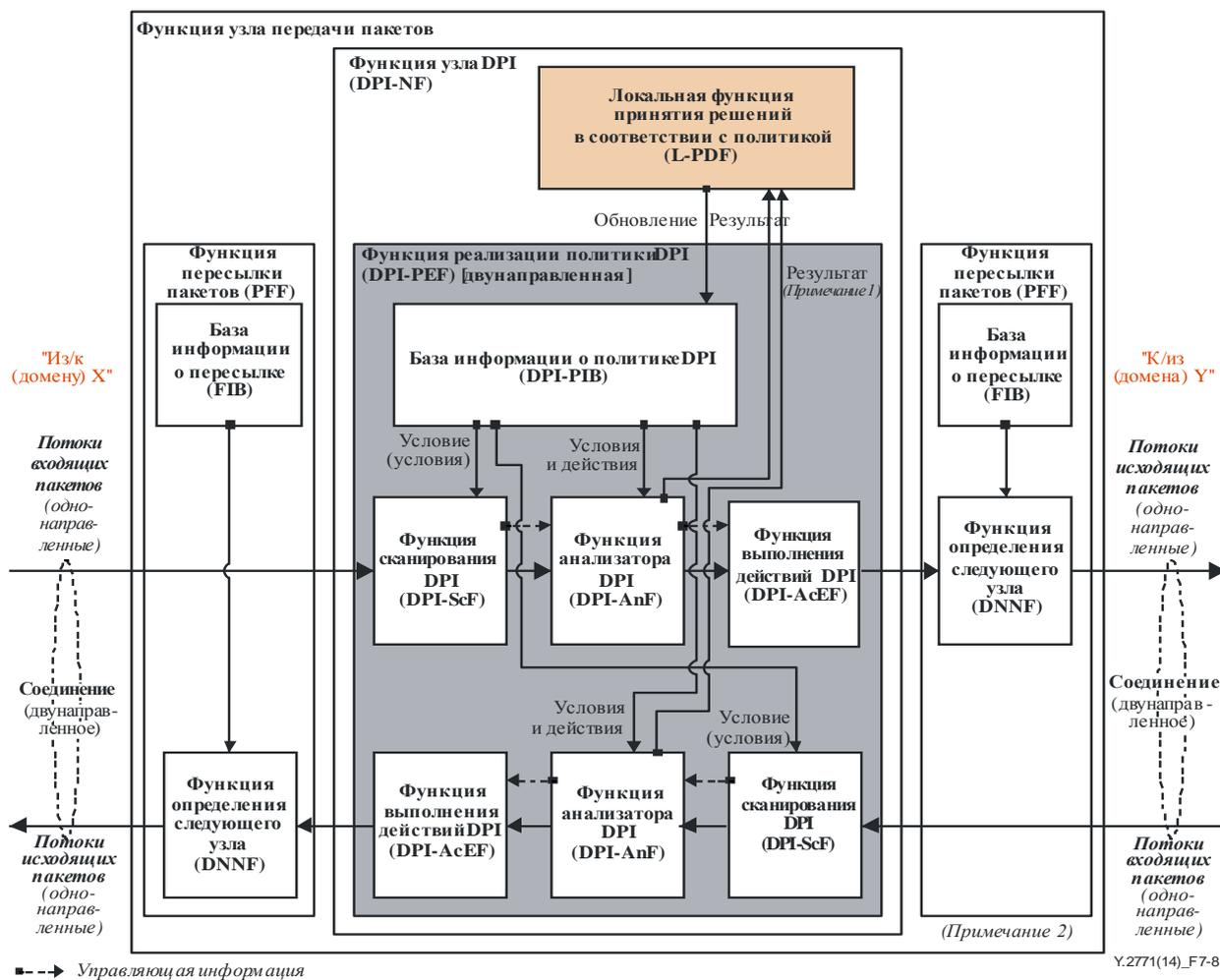
ПРИМЕЧАНИЕ 1. DPI-PIB может быть внутренне разделена на базы, зависящие от направления, DPI-PIB, например DPI<sub>x→y</sub>-PIB и DPI<sub>y→x</sub>-PIB.
