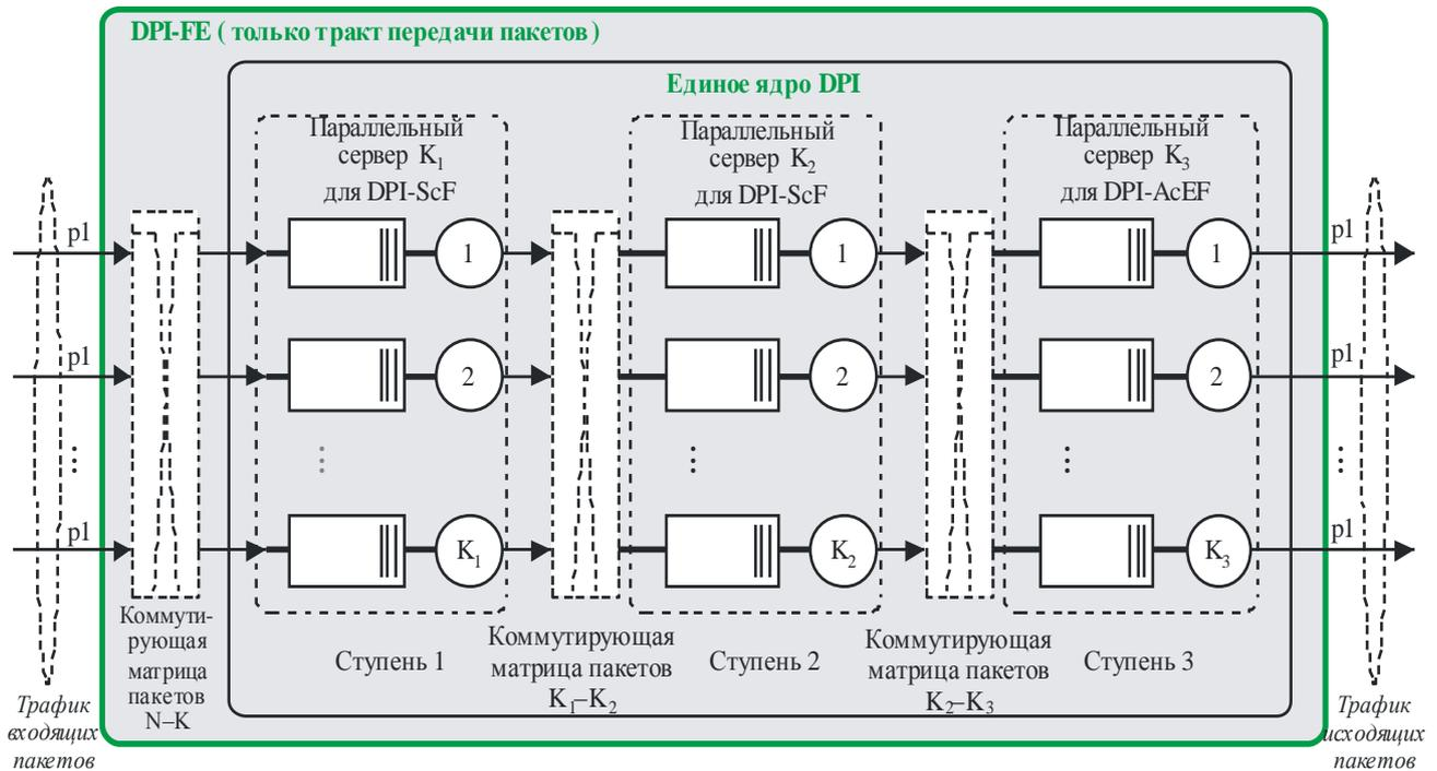
**Рисунок 7-21. Единое ядро DPI на базе трех ступеней и внутреннего параллелизма (несколько внешних интерфейсов)**
