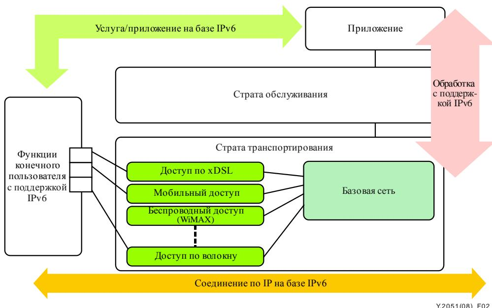
Рисунок 2 – Обзор СПП на базе IPv6
