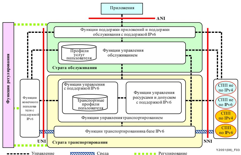
Рисунок 3 – Функциональная архитектура СПП на базе IPv6
