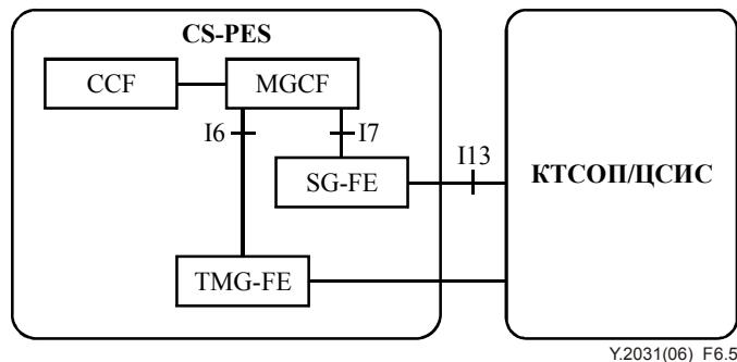
**Рисунок 6-5 – Архитектура компонента услуги эмуляции сетей КТСОП/ЦСИС на основе сервера вызова, взаимодействующего с КТСОП/ЦСИС**
