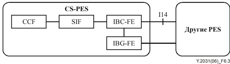
**Рисунок 6-3 – Архитектура компонента услуги эмуляции сетей КТСОП/ЦСИС на основе сервера вызова, взаимодействующего с другими компонентами услуги эмуляции сетей КТСОП/ЦСИС**
