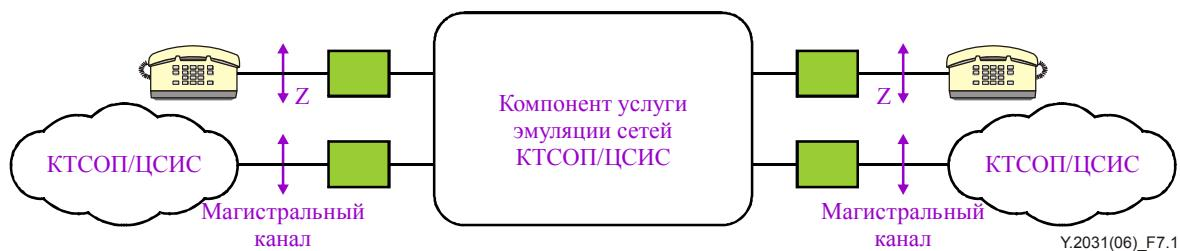
**Рисунок 7-1 – Традиционная конфигурация, поддерживаемая функциональной архитектурой эмуляции сетей КТСОП/ЦСИС на основе IMS**
