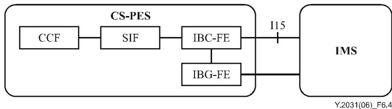
**Рисунок 6-4 – Архитектура компонента услуги эмуляции сетей КТСОП/ЦСИС на основе сервера вызова, взаимодействующего с IMS**
