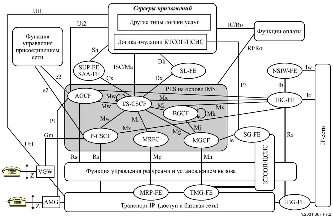
**Рисунок 7-2 – Функциональная архитектура компонента услуги эмуляции сетей КТСОП/ЦСИС на основе IMS**
