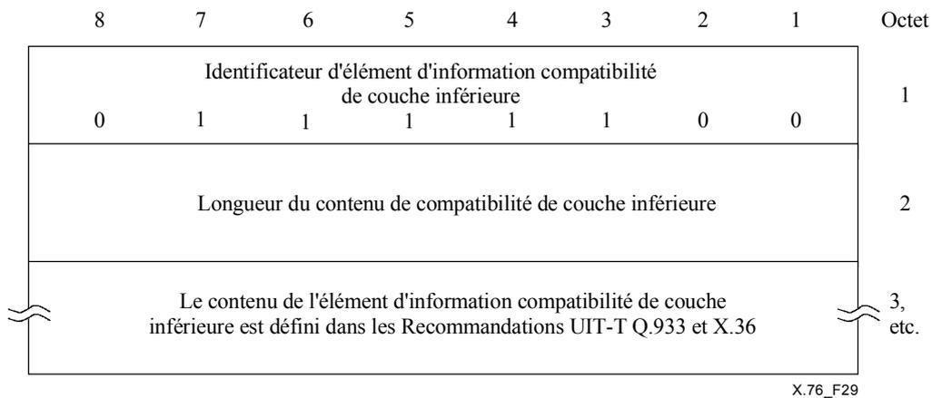
**Figure 29/X.76 – Élément d'information compatibilité de couche inférieure**
