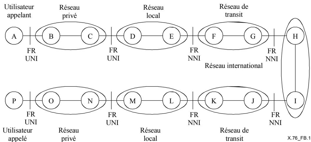
NOTE 2 – Les interfaces A-B, C-D, M-N et O-P sont supposées être des interfaces utilisateur-réseau par relais de trames (FR-UNI).
