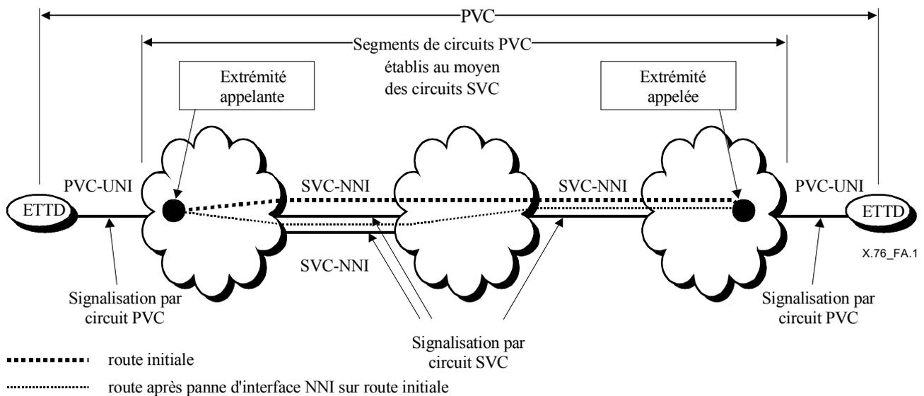
**Figure A.1/X.76 – Configuration de référence des circuits SPVC**
