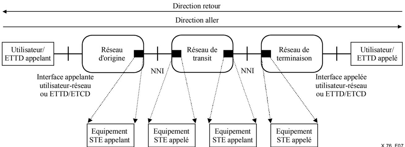
**Figure 7/X.76 – Conventions utilisées pour la signalisation des circuits SVC**
