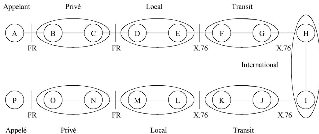
NOTE 1 – Les interfaces A-B, C-D, M-N et O-P sont supposées être des interfaces utilisateur-réseau par relais de trames (FR-UNI).
