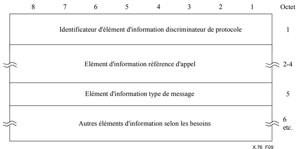
**Figure 9/X.76 – Exemple général de structure d'un message**
