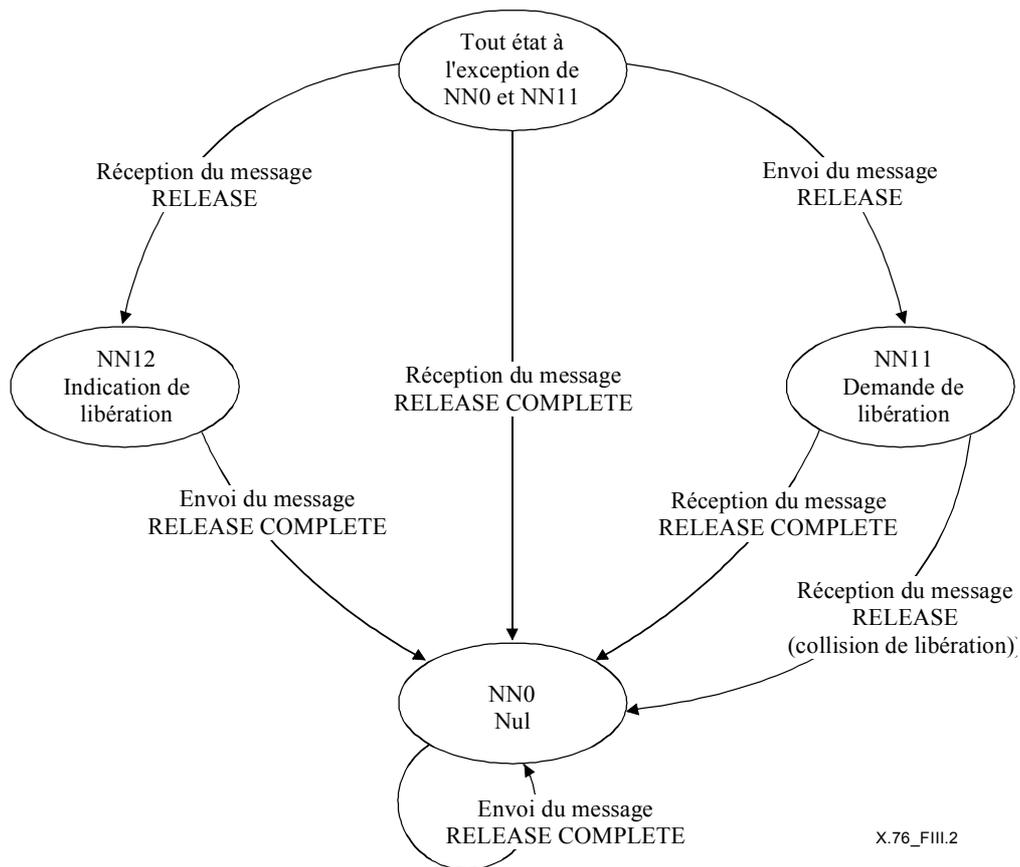
**Figure III.2/X.76 – Diagramme des états d'appel pour le transfert des messages de libération de la communication à une extrémité de l'interface NNI**
