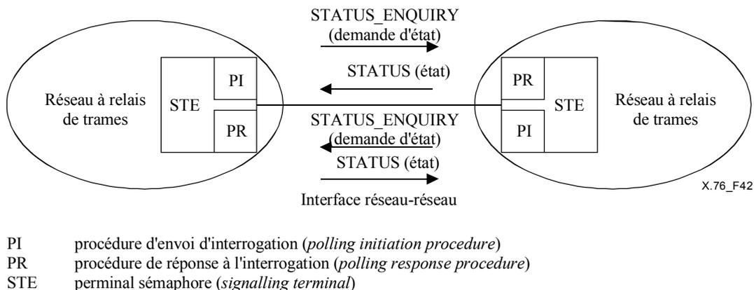
**Figure 42/X76 – Procédures bidirectionnelles de signalisation**
