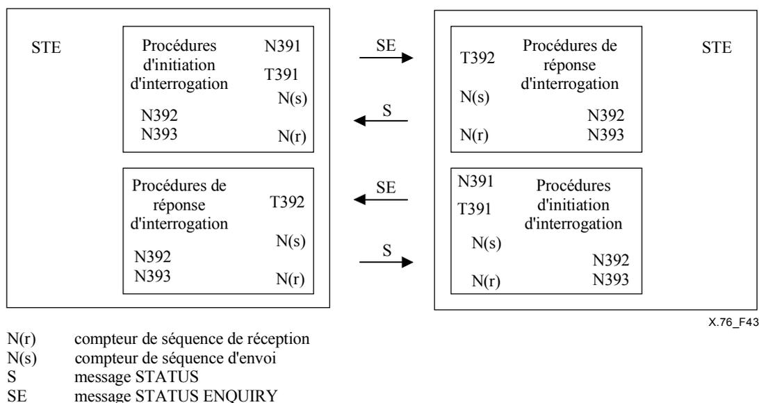
**Figure 43/X.76 – Implantation des paramètres et variables du système**
