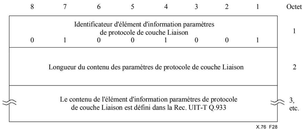
**Figure 28/X.76 – Élément d'information paramètres de protocole de couche Liaison**
