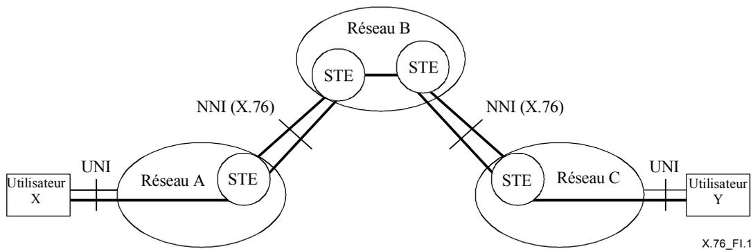
**Figure I.1/X.76 – Circuit virtuel permanent multisegment illustrant les scénarios de congestion**
