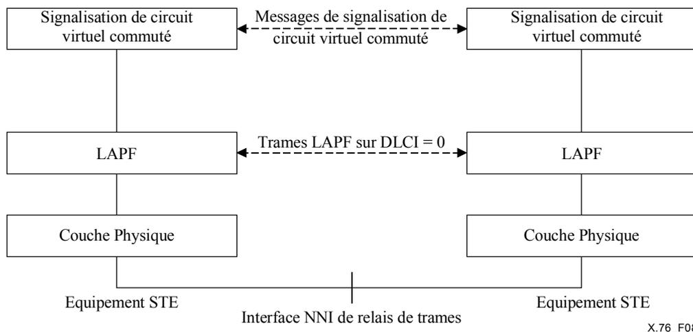
**Figure 8/X.76 – Couches de protocole STE/STE pour la signalisation**
