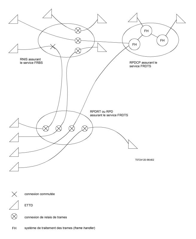
Figure 2/X.7 – Divers réseaux assurant le service de transmission de données à relais de trames (FRDTS) et le service support à relais de trames (FRBS)
