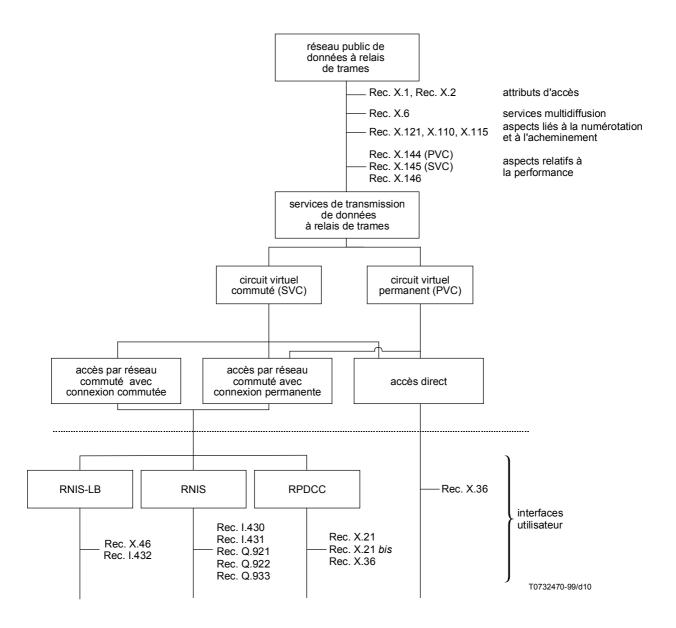
Figure 10/X.7 – Recommandations sur les caractéristiques techniques des services de transmission de données à relais de trames d'un RPDRT
