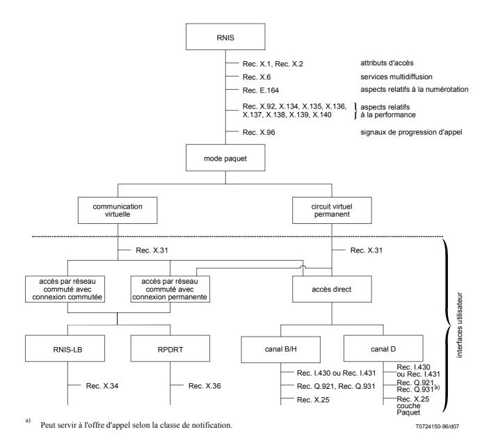
Figure 7/X.7 – Recommandations de la série X sur les caractéristiques techniques des services de transmission de données à commutation de paquets sur les RNIS
