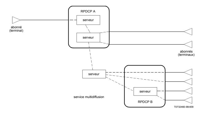
Figure 9/X.7 – Exemple de réalisation d'un serveur multidiffusion
