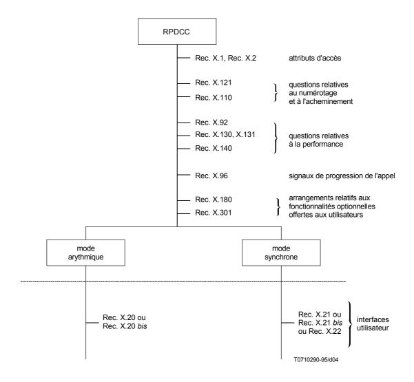
Figure 4/X.7 – Recommandations de la série X portant sur les caractéristiques techniques des services de transmission de données à commutation de circuits dans les RPDCC
