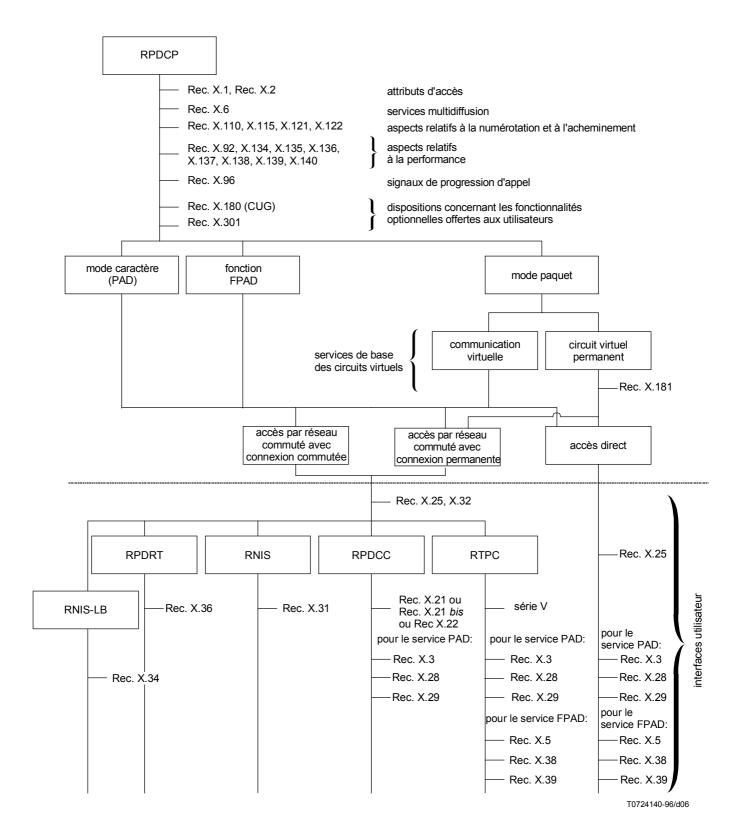
Figure 6/X.7 – Recommandations de la série X sur les caractéristiques techniques des services de transmission de données à commutation de paquets sur les RPDCP
