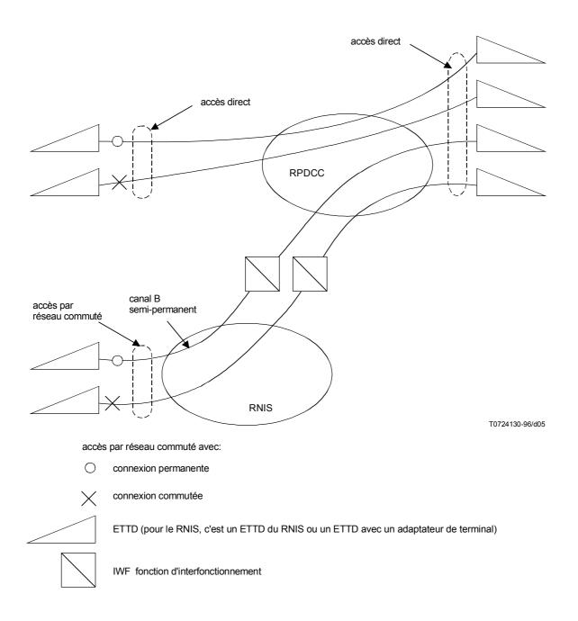
Figure 5/X.7 – Mécanismes d'accès pour les services de transmission de données à commutation de circuits assurés par le RPDCC
