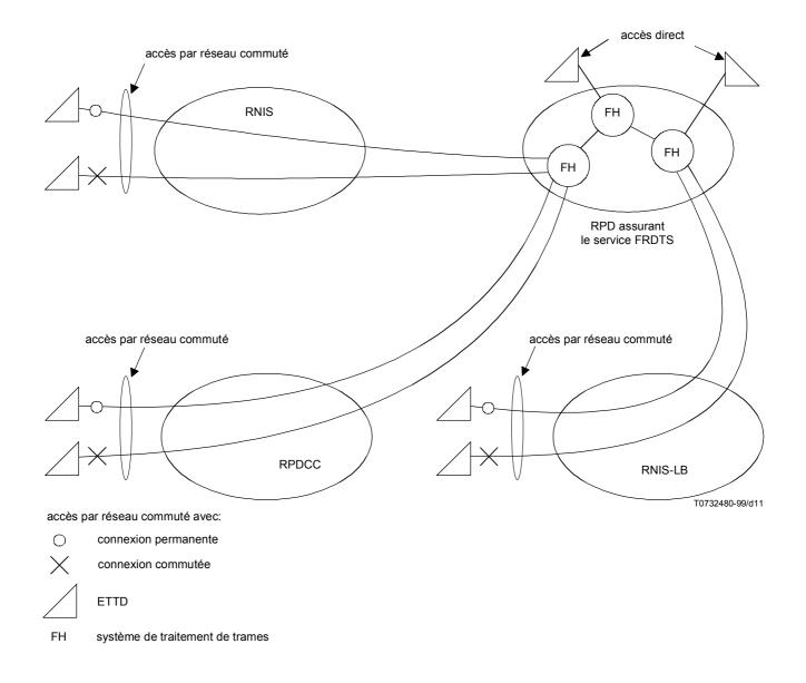
Figure 11/X.7 – Mécanismes d'accès des services de transmission de données à relais de trames
