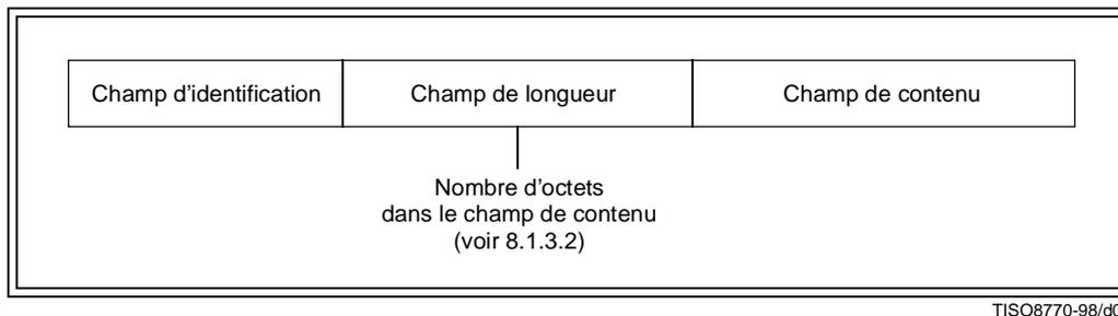
Figure 1 – Structure d'un codage
