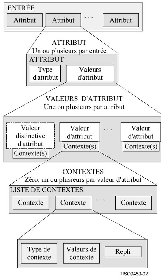
**Figure 3 – Structure d'une entrée**
