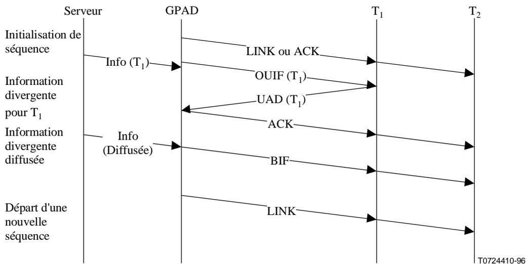
**Figure I.2/X.42 – Transmission divergente non sollicitée**
