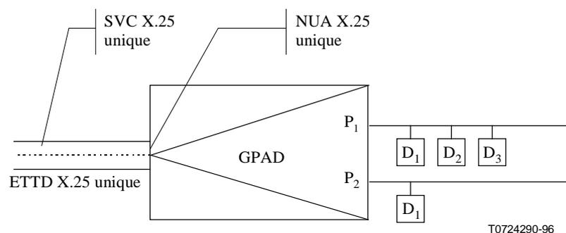
**Figure 2/X.42 – Configuration minimale d'un équipement GPAD**
