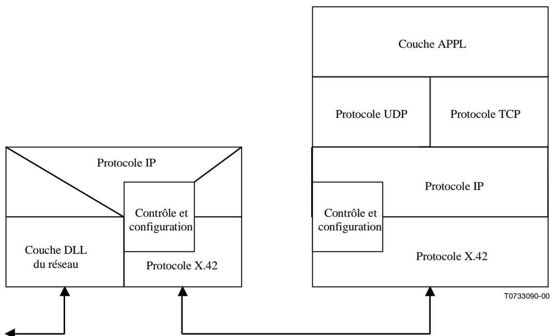
**Figure 7/X.42 – Organisation interne de l'équipement GPAD Terminal pouvant utiliser le protocole IP; classe de procédure du mode d'encapsulation selon le protocole X.42**
