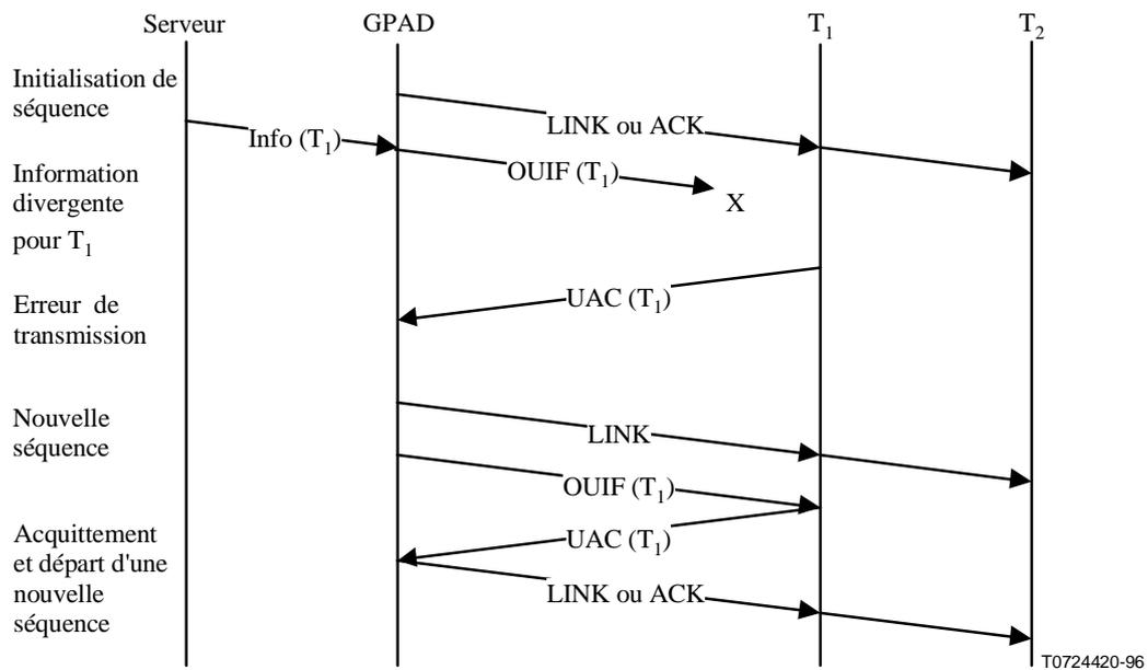
**Figure I.3/X.42 – Erreur de transmission divergente non sollicitée**
