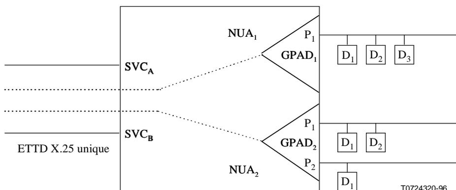
**Figure 5/X.42 – Configuration élargie d'un équipement PAD – Deux instances GPAD**
