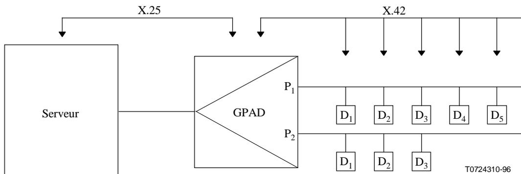
**Figure 4/X.42 – Architecture minimale d'un équipement GPAD – Implémentée en réseau**
