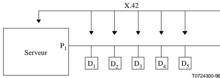
**Figure 3/X.42 – Architecture minimale d'un équipement GPAD – Multipoint traditionnel**
