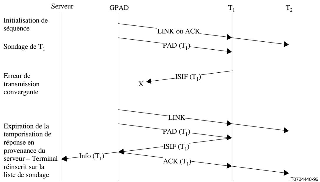
**Figure I.5/X.42 – Erreur de transmission convergente sollicitée**
