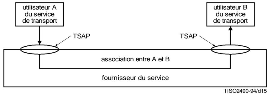
Figure 14a – Modèle de transmission en mode sans connexion
