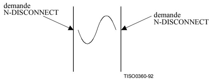
**Figure 7 – Enchaînement de primitives correspondant à une libération de la connexion de réseau invoquée simultanément par les deux utilisateurs du service de réseau**
