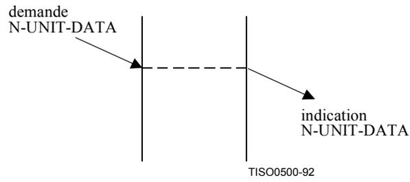
Figure 21a – Enchaînement des primitives dans une transmission de réseau en mode sans connexion
