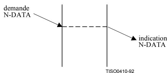
**Figure 12 – Enchaînement de primitives correspondant à un transfert de données**
