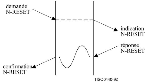
**Figure 15 – Enchaînement de primitives correspondant à une réinitialisation invoquée par un utilisateur du service de réseau**
