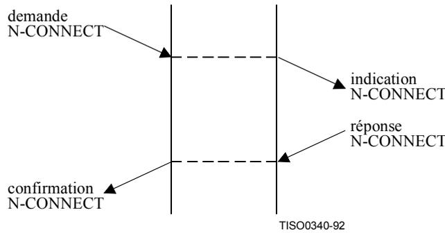
**Figure 5 – Enchaînement de primitives pour un établissement de connexion de réseau réussi**
