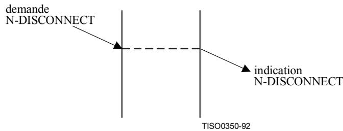
**Figure 6 – Enchaînement de primitives correspondant à une libération de la connexion de réseau invoquée par un utilisateur du service de réseau**
