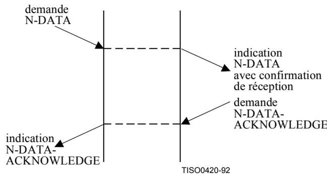
**Figure 13 – Enchaînement de primitives correspondant à un transfert de données correct avec confirmation de réception**
