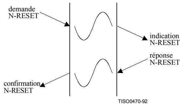
**Figure 18 – Enchaînement de primitives correspondant à une réinitialisation invoquée simultanément par un utilisateur et par le fournisseur du service de réseau**
