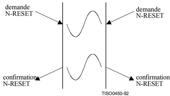
**Figure 16 – Enchaînement de primitives correspondant à une réinitialisation invoquée simultanément par les deux utilisateurs du service de réseau**
