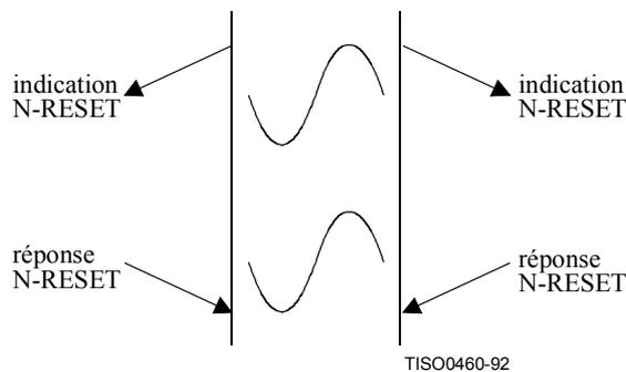
**Figure 17 – Enchaînement de primitives correspondant à une réinitialisation invoquée par les fournisseur du service de réseau**
