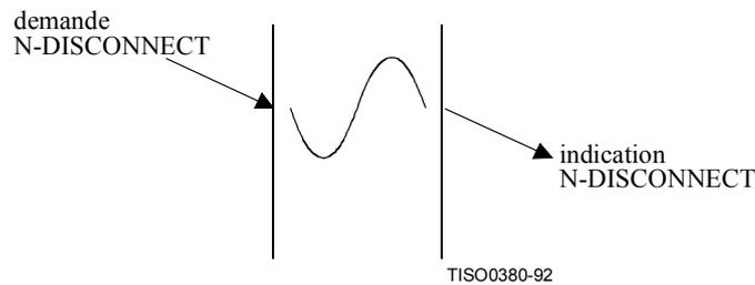
**Figure 9 – Enchaînement de primitives correspondant à une libération de la connexion de réseau invoquée simultanément par un utilisateur et par le fournisseur du service de réseau**
