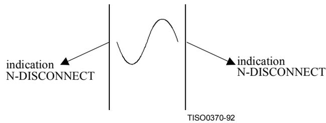
**Figure 8 – Enchaînement de primitives correspondant à une libération de la connexion de réseau invoquée par le fournisseur du service de réseau**
