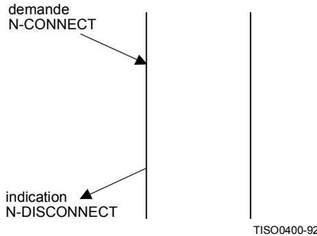
**Figure 11 – Enchaînement de primitives correspondant au refus par le fournisseur du service de réseau d'une tentative d'établissement d'une connexion de réseau**
