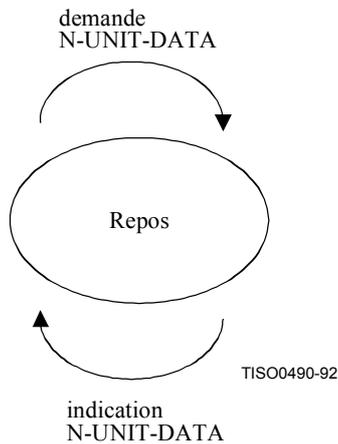
**Figure 20 – Diagramme de transition d'état représentant les enchaînements de primitives en mode sans connexion au niveau d'un point NSAP**
