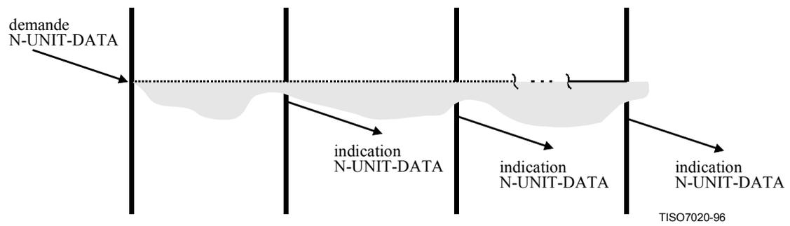
Figure 21b – Enchaînement des primitives dans une transmission de réseau en mode sans connexion
