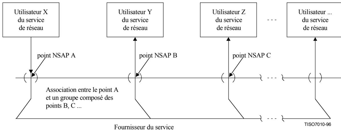
**Figure 19b – Modèle de multidiffusion de réseau en mode sans connexion**
