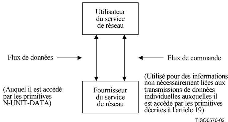
Figure C.1 – Flux de commande du point de vue de l'utilisateur du service de réseau
