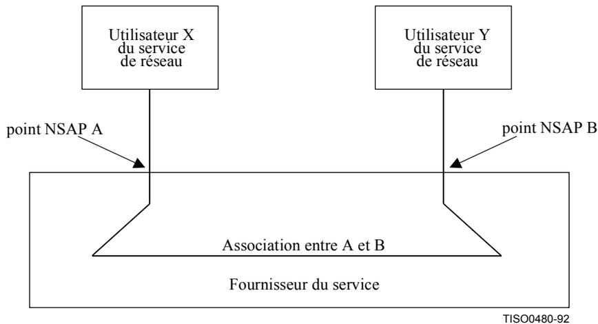
Figure 19a – Modèle de transmission sur le réseau en mode sans connexion
