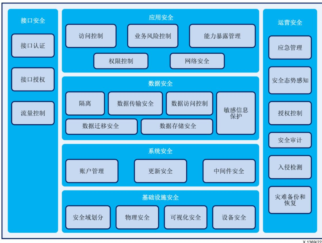
图3 – 物联网服务平台的安全架构
