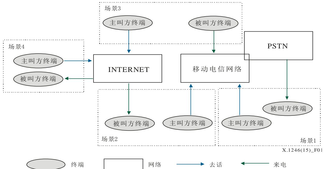
图1 – 电信网络中的语音通信
