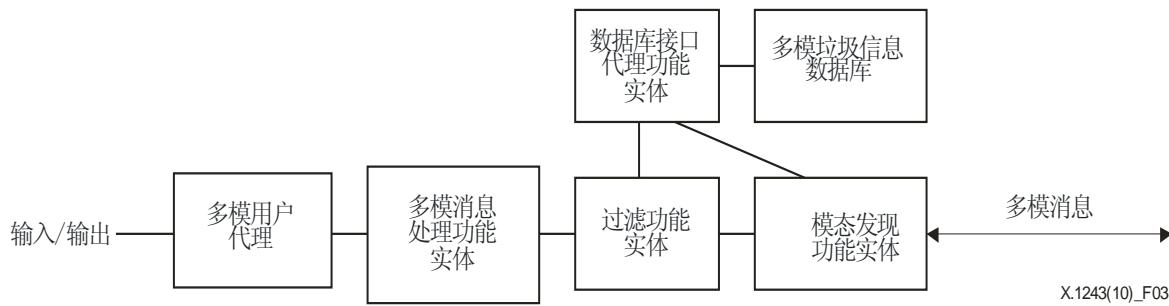
图 3 – 多模过滤架构
