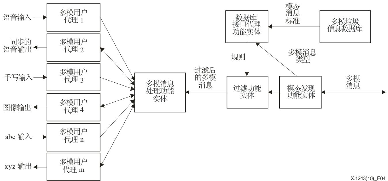
图 4 – 接收者网关功能（RGF）中的多模过滤
